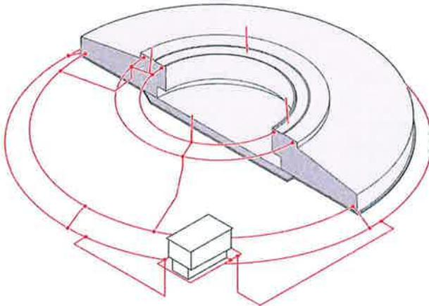
**Abb. 4: Erdungsanlage, Beispiel**
