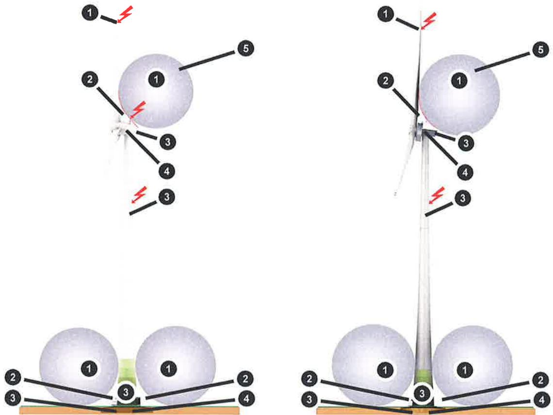
Abb. 1: Blitzschutzzonen, Gondel in Tropfenform (links) und Gondel in Kompaktform/E-Gondel (rechts), Beispiel
