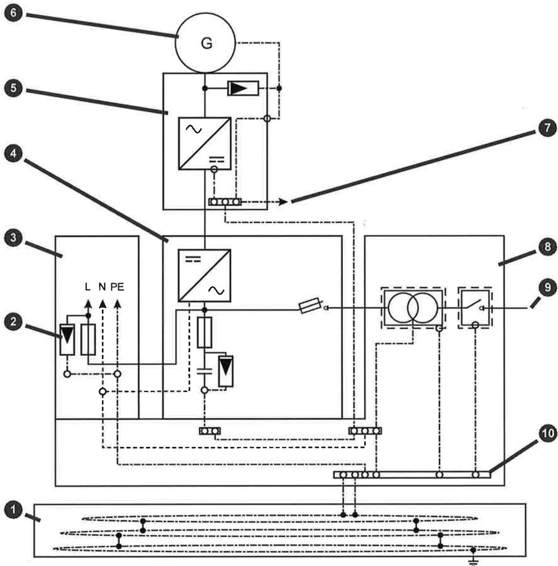
**Abb. 5: Schematischer Aufbau des Potentialausgleichssystems und der Überspannungsableiter**
