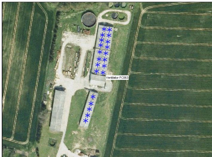
Lage der 21 Ventilatoren der Schweinemastanlage Dambeck
