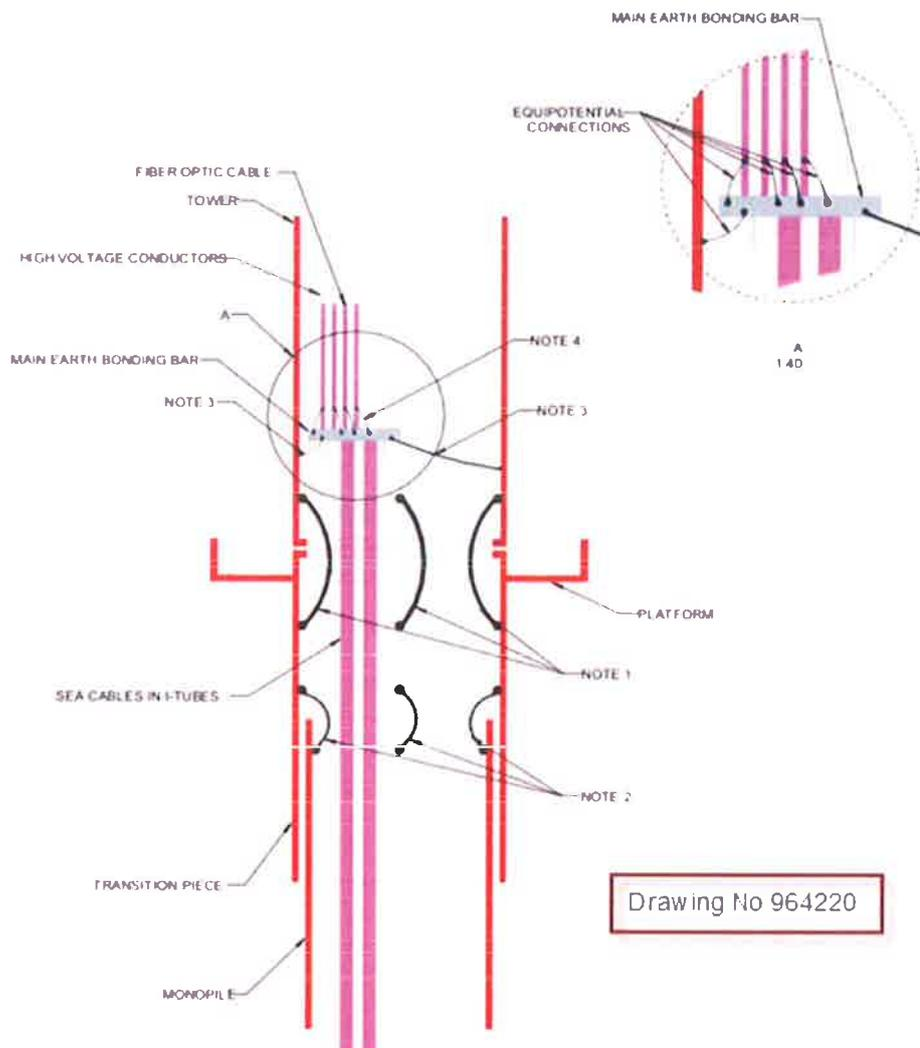
**Abbildung 3.13: Prinzipdarstellung des Vestas-Erdungssystems bei I-Rohr-Aufstellung**
