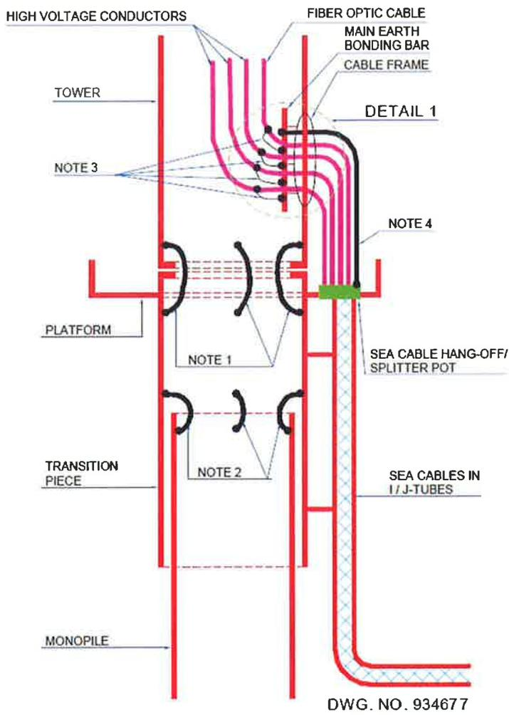
Abbildung 3.12: Prinzipdarstellung des Vestas-Erdungssystems bei J-Rohr-Aufstellung
