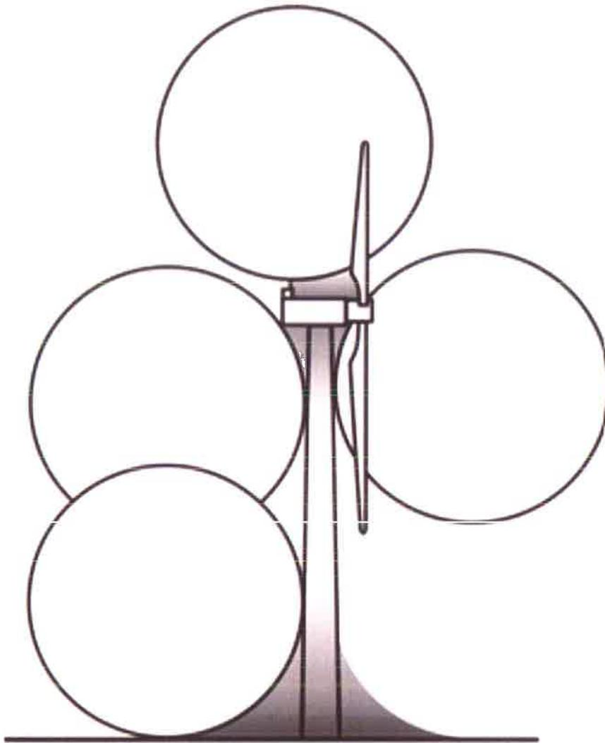
Abbildung 3.1: Das „Rollkugelverfahren“
