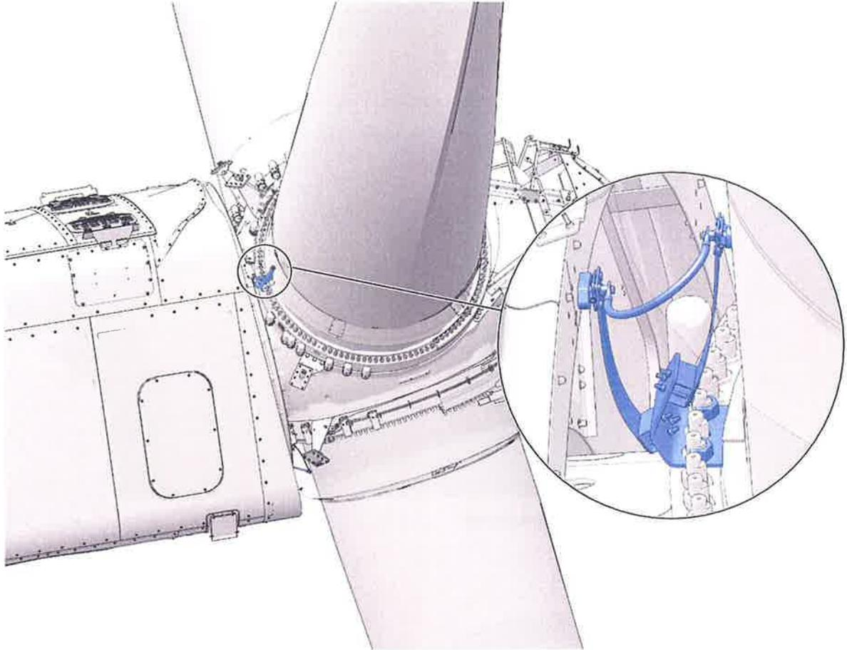
**Abbildung 3.6: Blitzstromableiter zwischen den Rotorblättern und der Maschinenhausstruktur**
