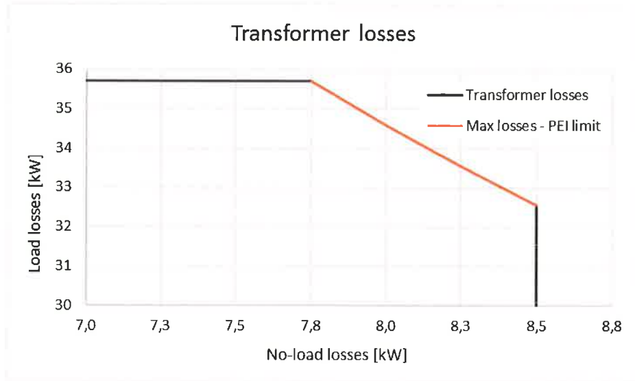
Abbildung 4-1 Transformatorverluste – zulässiger Bereich
