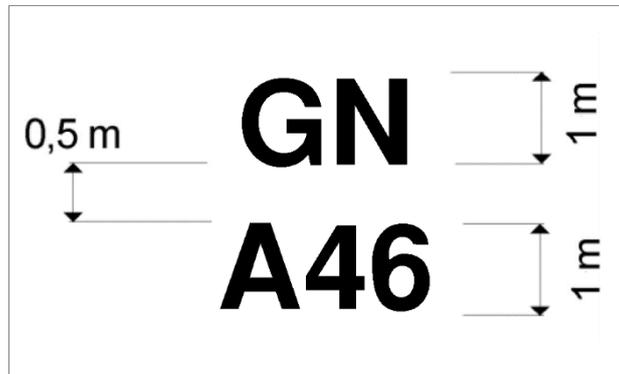
Abb. 3: Prinzipdarstellung der Geometrie der Beschriftung
