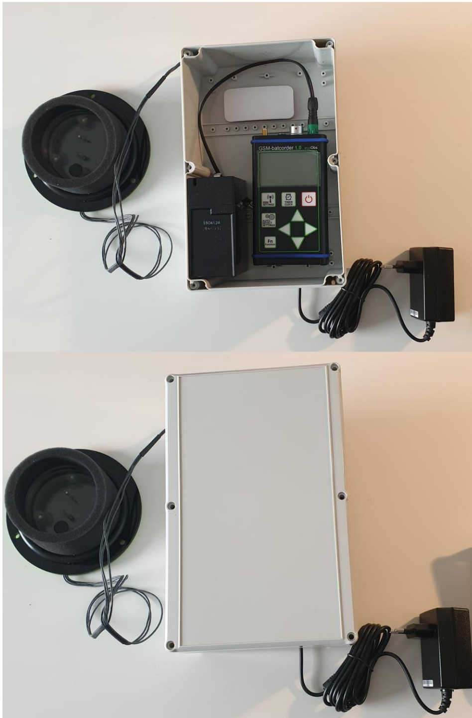
Abbildung 4: Beispielhaftes Setup eines Batcorder-Erfassungssystems im Polycarbonatgehäuse (Quelle: IfAÖ GmbH)
