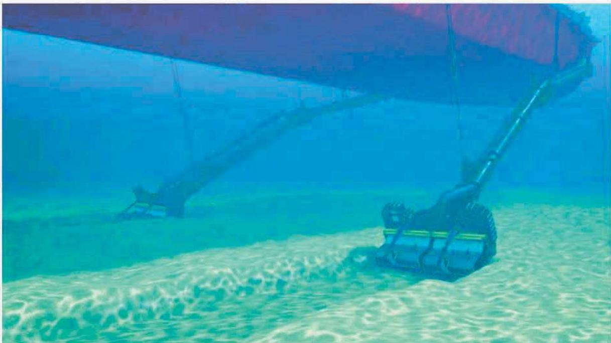
Abbildung 3: Modell und Wirkprinzip eines Laderaumsaugbaggers („Hopperbagger“)
