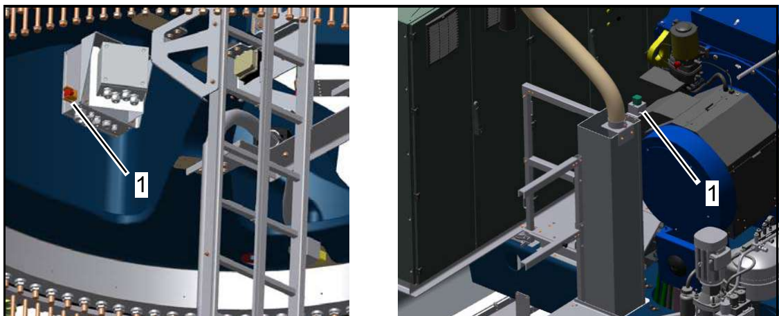
Abb. 24: Ausschalter Mittelspannung (1) an Box 8 und am Kettenkasten des Elektrokettzugs
