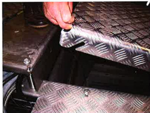
Abbildung 14-3: Öffnen der Bodenplatte
