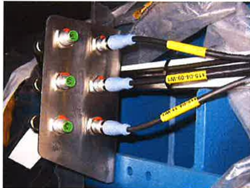
Abbildung 22–5: Nahaufnahme der PT100-Sensorverbindungen
