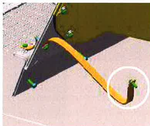
Abbildung 21–5: M8-Schraubverbindung zur Strebe
