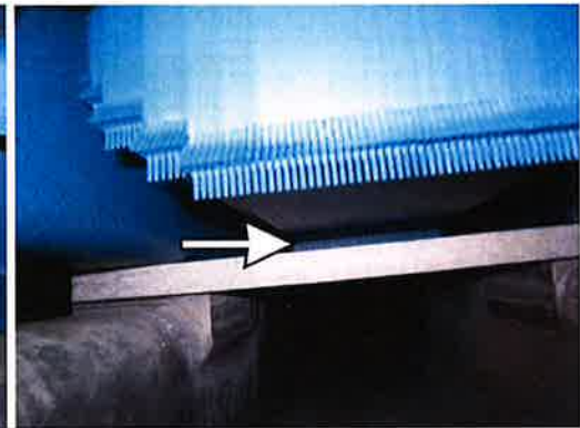
Abbildung 24-15: Isolierplatte unter dem Eisenkern
