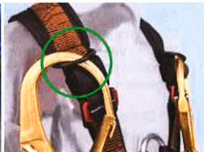
Abbildung 9-9: Befestigung der Ankerverbindung am Auffang- und Rettungsgurt
