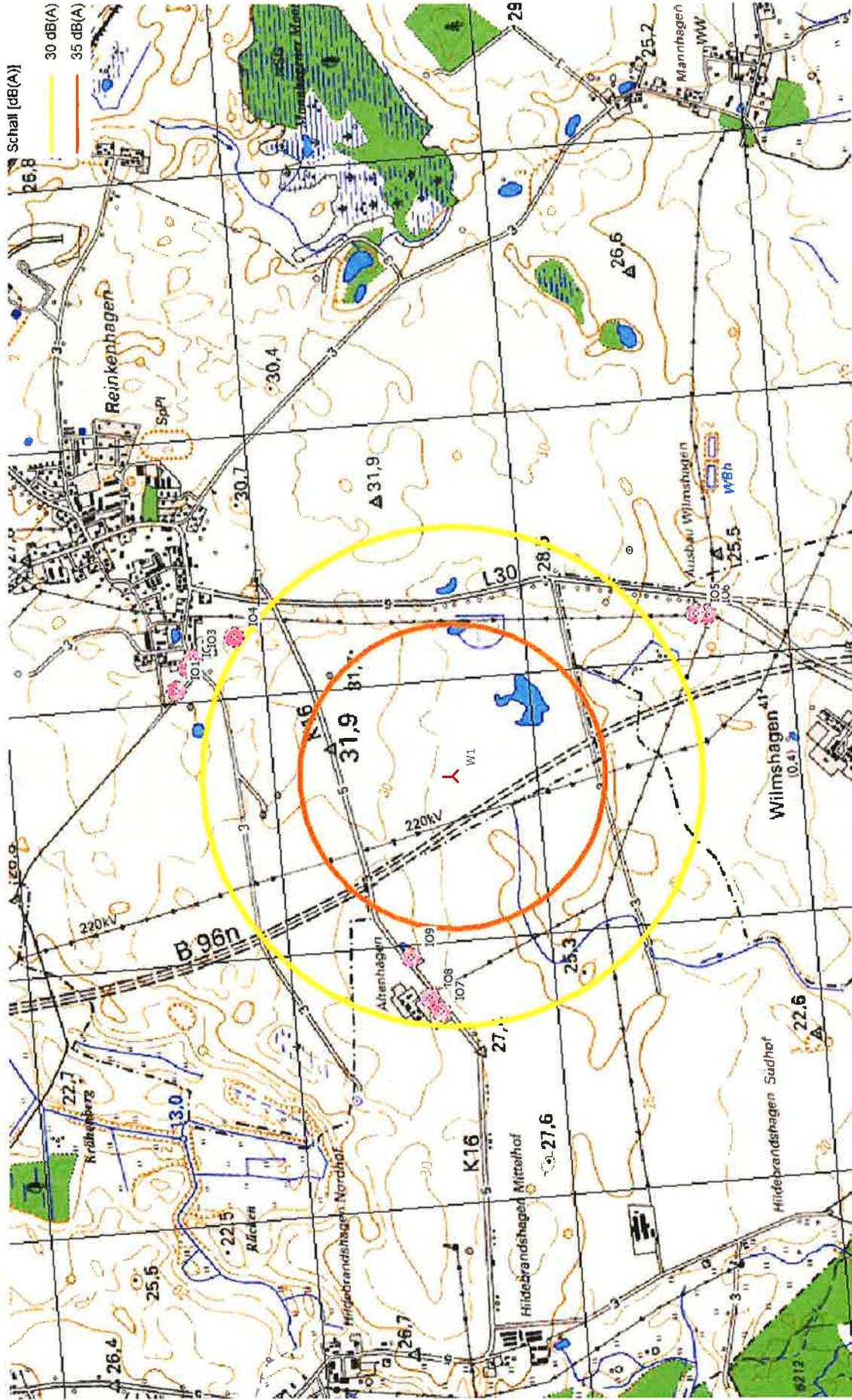
Abbildung 9.1: Einwirkungsbereich der geplanten WEA Vestas V112-3.3/3.45MW Mode 8+ Schall – Isolinie (nachts)
