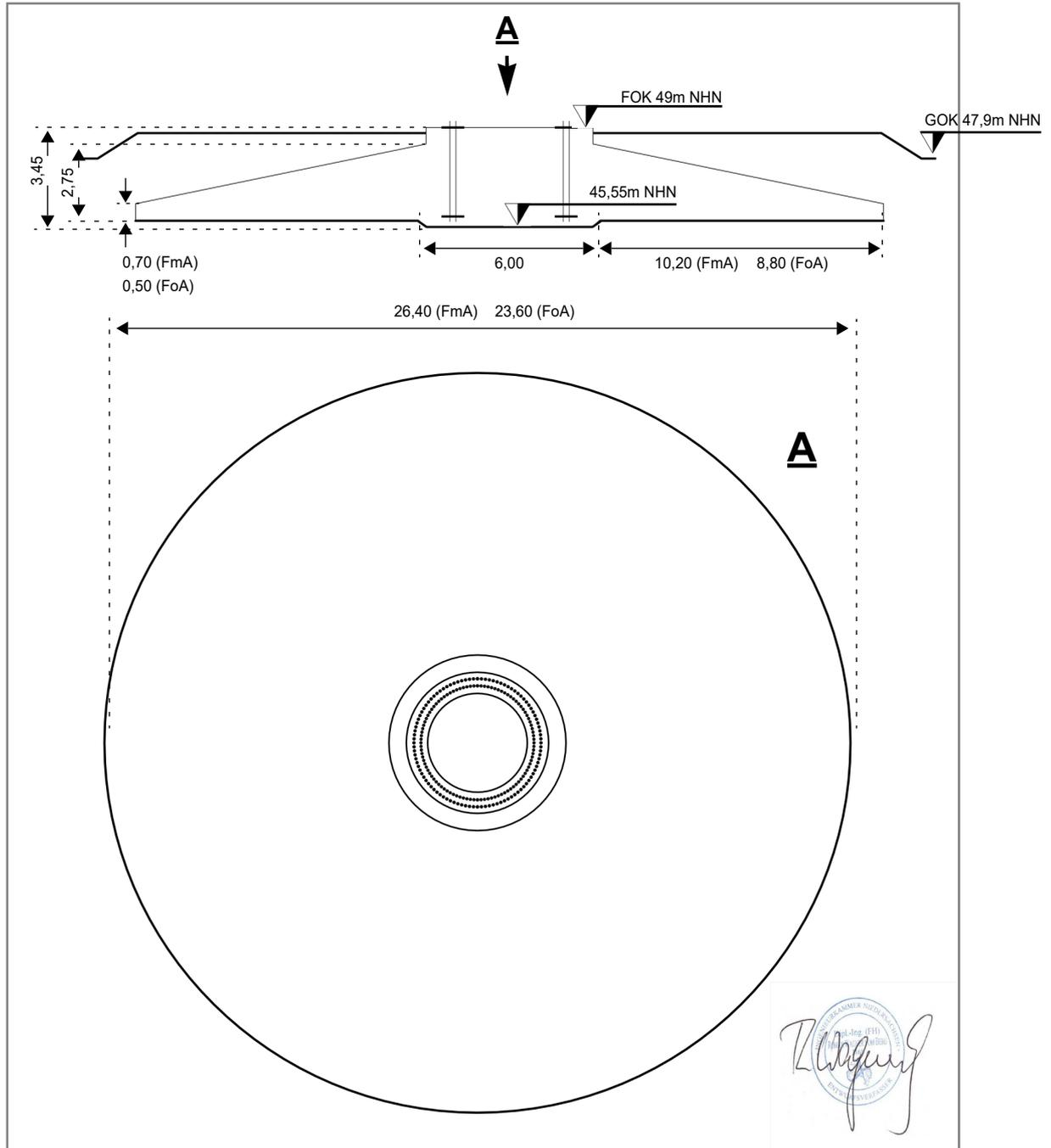
*Darstellung eines Typenfundaments für eine N149/5.X mit 125,4 m Nabhöhe (alle Angaben in Metern, nicht maßstabgerecht)*
