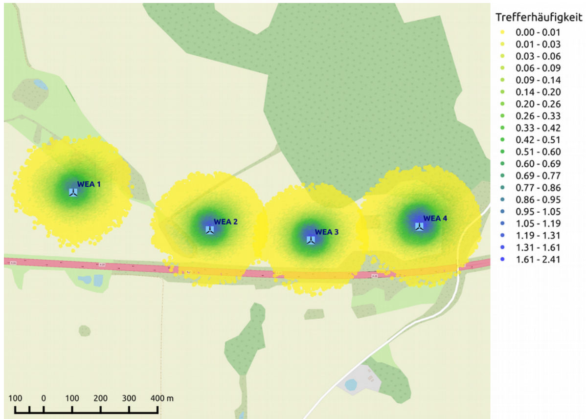
Abbildung B.1.1: Trefferhäufigkeiten von Eisstücken pro Rasterfläche (16m 2 ) und Jahr in der Umgebung der WEA 1 - 4 am Standort Dummerstorf (Karte /1.4/).
