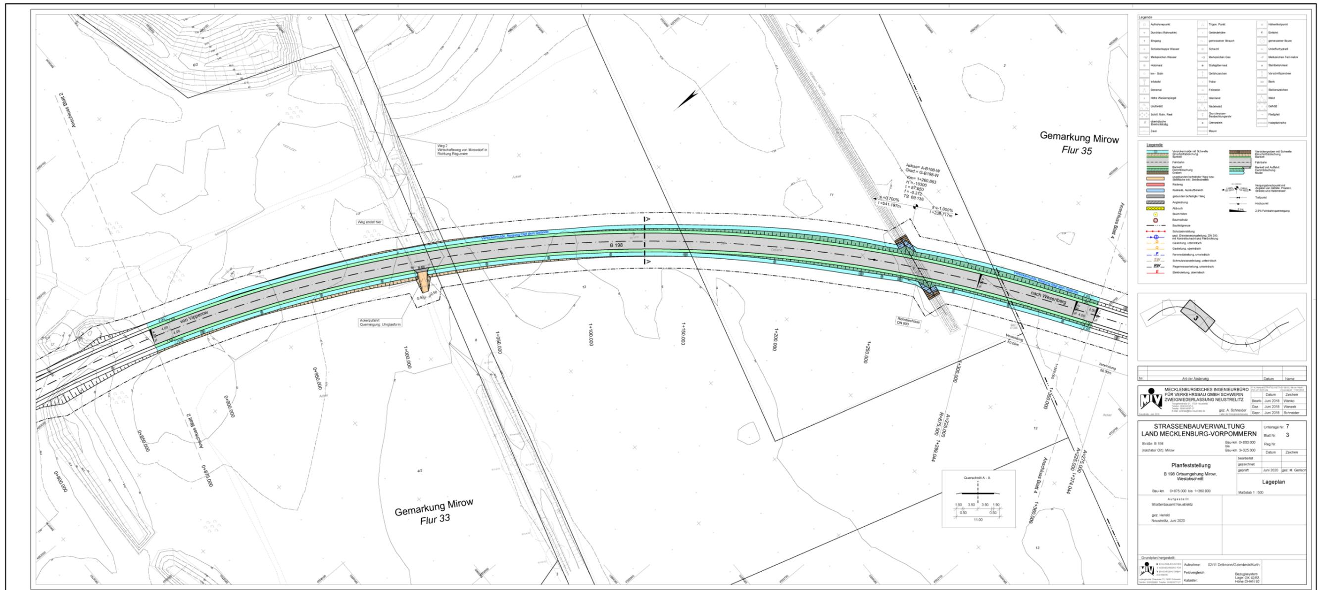
Abb. 4: Lageplan Blatt 3 von 7 zur Planfeststellungsunterlage zum Projekt "B 198 Ortsumgehung Mirow, Westabschnitt" für den Bau-km Bereich 0+875 bis 1+360 im Maßstab 1:500 (nachrichtliche Übernahme MIV NEUSTRELITZ 2020d)
