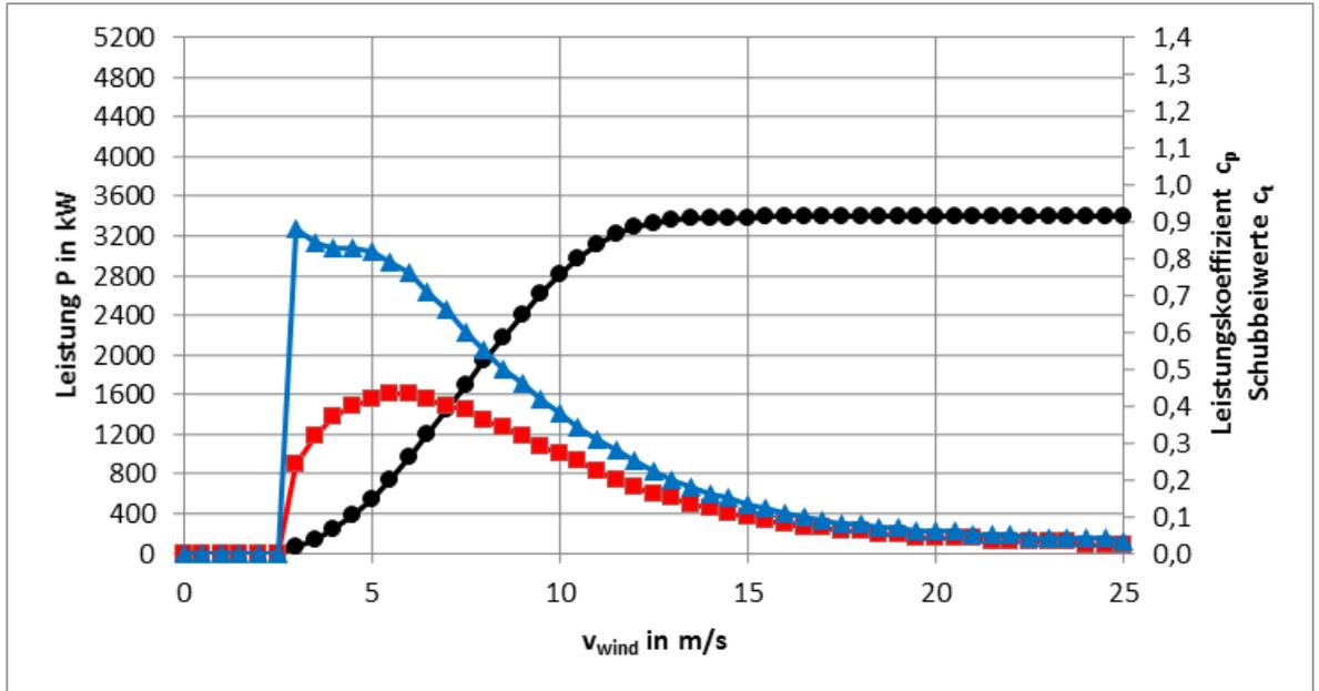
Abb. 5: Leistungs-, c<sub>p</sub>- und c<sub>t</sub>-Kennlinien E-147 EP5 E2 / 5000 kW Betriebsmodus 101,3 dB
