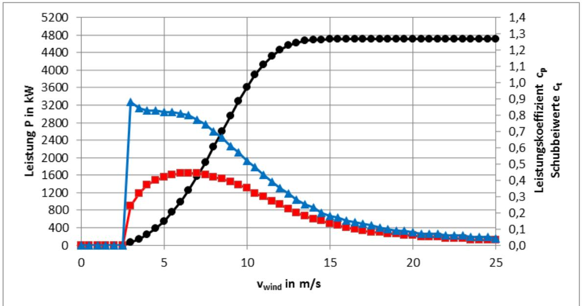
Abb. 1: Leistungs-,  $c_p$ - und  $c_t$ -Kennlinien E-147 EP5 E2 / 5000 kW Betriebsmodus 105,4 dB
