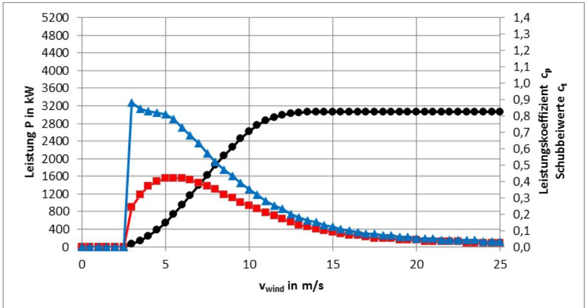
Abb. 6: Leistungs-,  $c_p$ - und  $c_t$ -Kennlinien E-147 EP5 E2 / 5000 kW Betriebsmodus 100,4 dB
