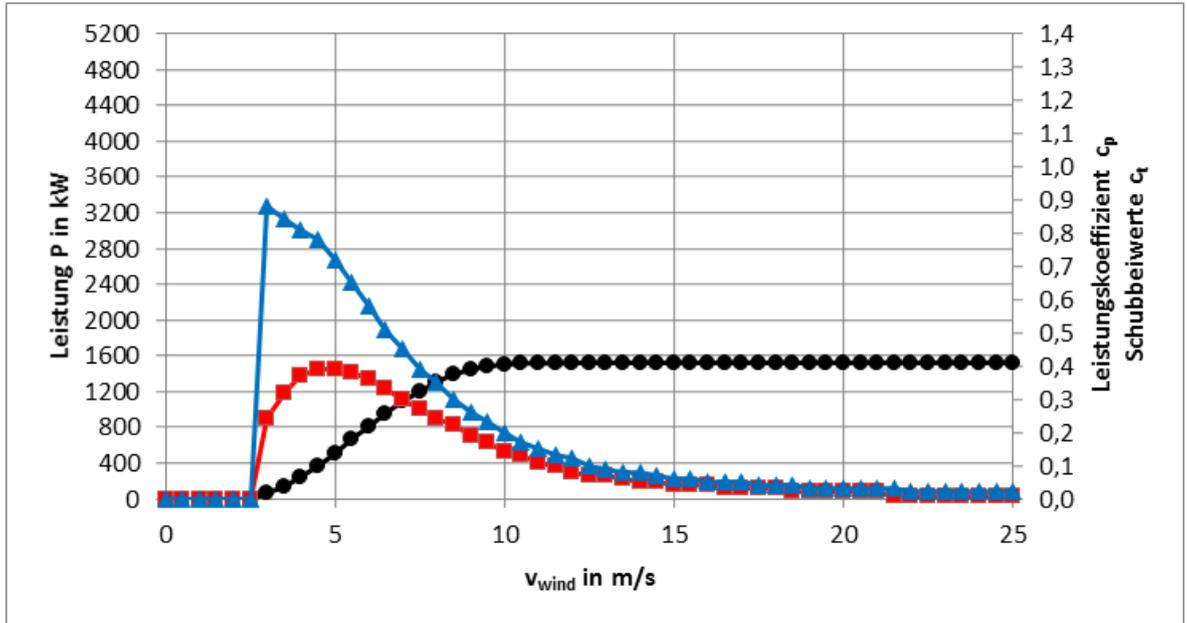
Abb. 9: Leistungs-,  $c_p$ - und  $c_t$ -Kennlinien E-147 EP5 E2 / 5000 kW Betriebsmodus 95,2 dB
