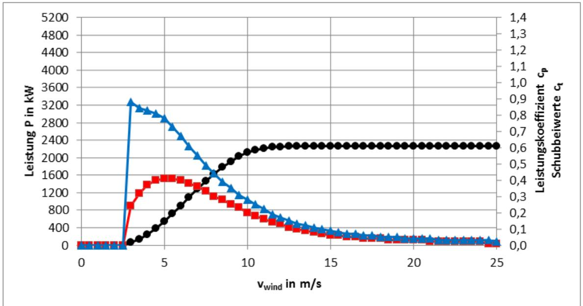
Abb. 8: Leistungs-,  $c_p$ - und  $c_t$ -Kennlinien E-147 EP5 E2 / 5000 kW Betriebsmodus 98,1 dB
