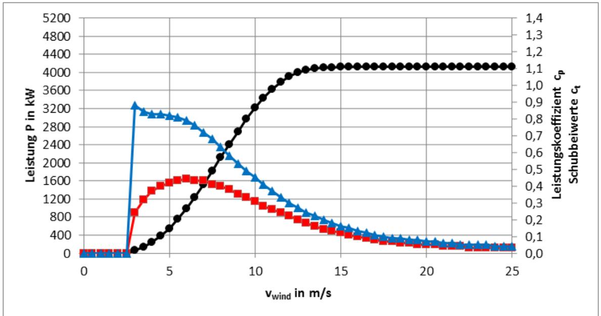
Abb. 3: Leistungs-,  $c_p$ - und  $c_t$ -Kennlinien E-147 EP5 E2 / 5000 kW Betriebsmodus 103,3 dB
