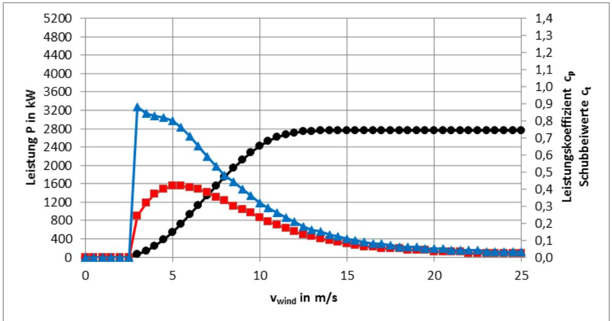
Abb. 7: Leistungs-, c<sub>p</sub>- und c<sub>t</sub>-Kennlinien E-147 EP5 E2 / 5000 kW Betriebsmodus 99,4 dB
