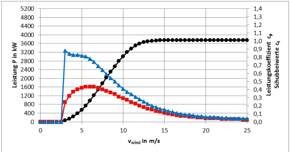
Abb. 4: Leistungs-,  $c_p$ - und  $c_t$ -Kennlinien E-147 EP5 E2 / 5000 kW Betriebsmodus 102,3 dB
