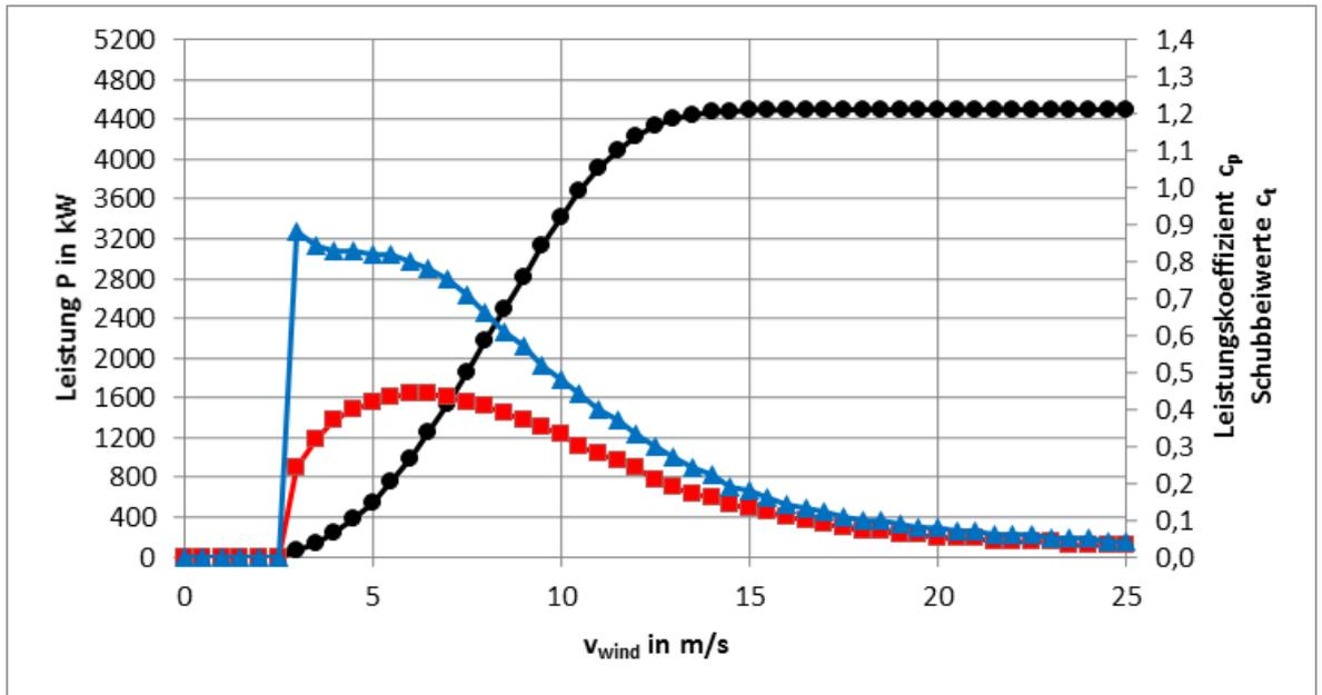
Abb. 2: Leistungs-,  $c_p$ - und  $c_t$ -Kennlinien E-147 EP5 E2 / 5000 kW Betriebsmodus 104,3 dB
