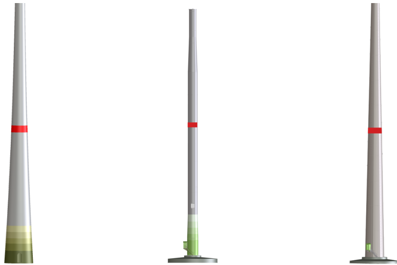
Abb. 5: Farbliche Kennzeichnung am Hybridturm (links), am Stahlrohrturm (mittig) und am modularen Stahlturm MST (rechts)
