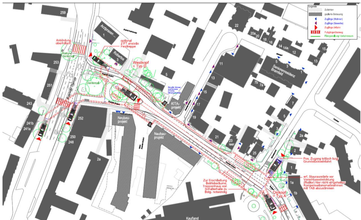
Abbildung 49: Darstellung Ausgänge Hst. BD – Variante mit Fußgängertunnel- Oberfläche
