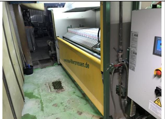
**Foto 22:** Kammerfilterpresse
