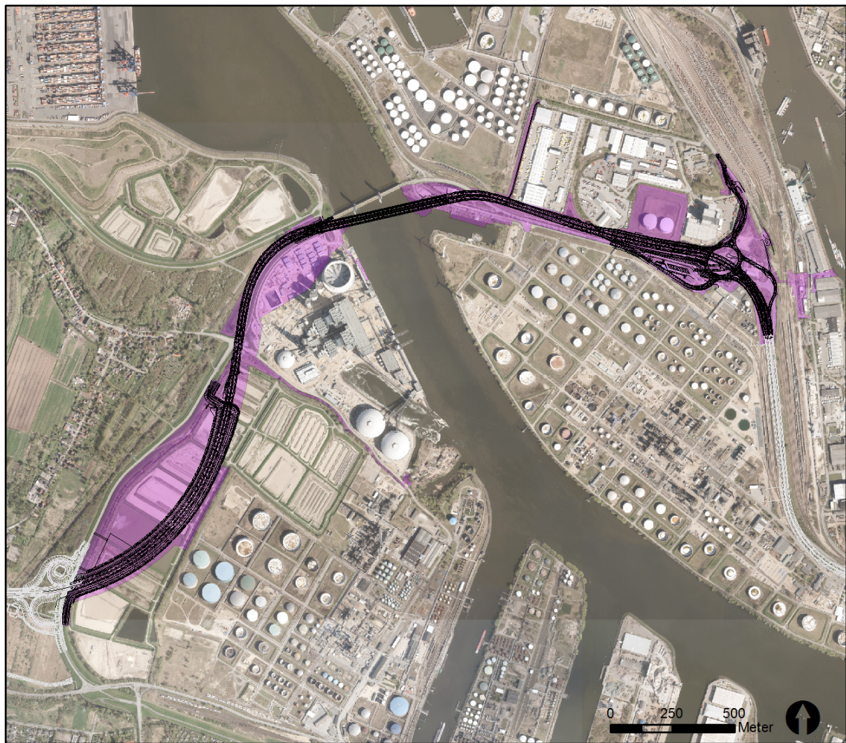
Abbildung 1: Lage der Trasse der geplanten A 26 Hafenpassage 6b und der Baueinrichtungsflächen (lila). Im Westen ist der geplante Abschnitt 6a dargestellt; im Osten schließt der Abschnitt 6c, ebenfalls in weiß dargestellt, an.
