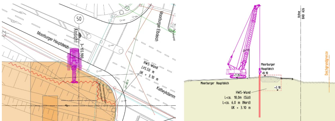
Abbildung 3-1: Pfeiler 50 Bauphase 1a, Einrammen der Spundwände. Skizze LAP
