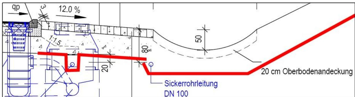
**Abb. 19:** Dichtungselemente (rot) im Randbereich der Trasse
