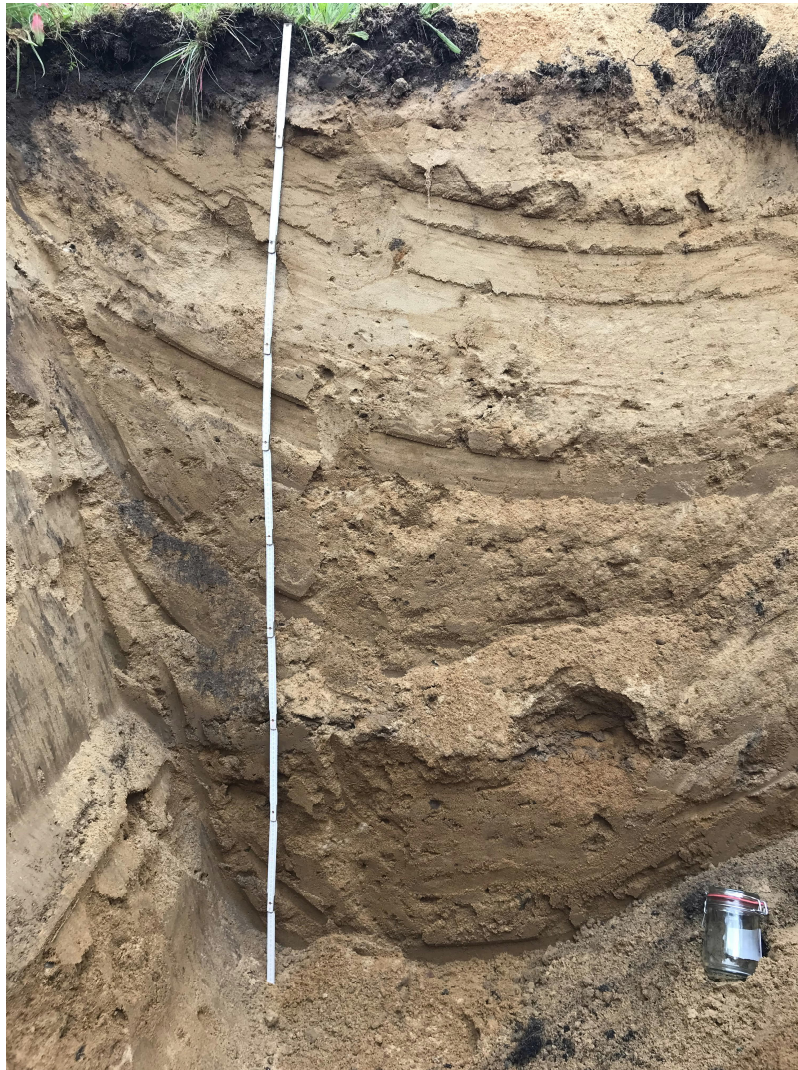
Abb. 2: Probeschurf A26-7054-West (WRW) zur Untersuchung des anfallenden Baugrubenwassers (westlicher Tunnelabschnitt – Segmente 00 bis 02, Lage des Schurfes siehe Anl. 1)
