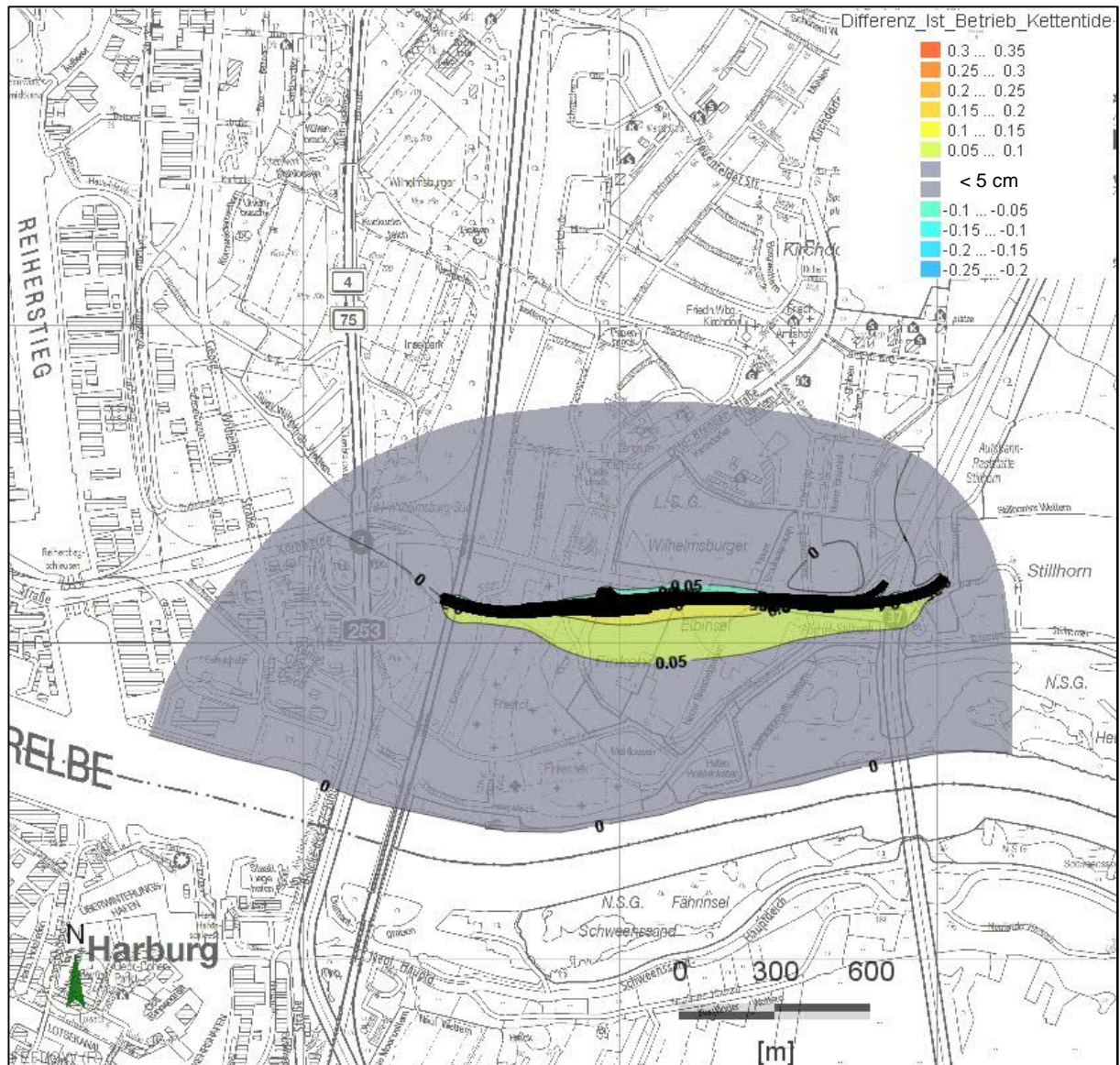
Abb. 13: Maximale Potenzialänderungen im 1. HGWL in cm (Kettentide, Betriebsphase)
