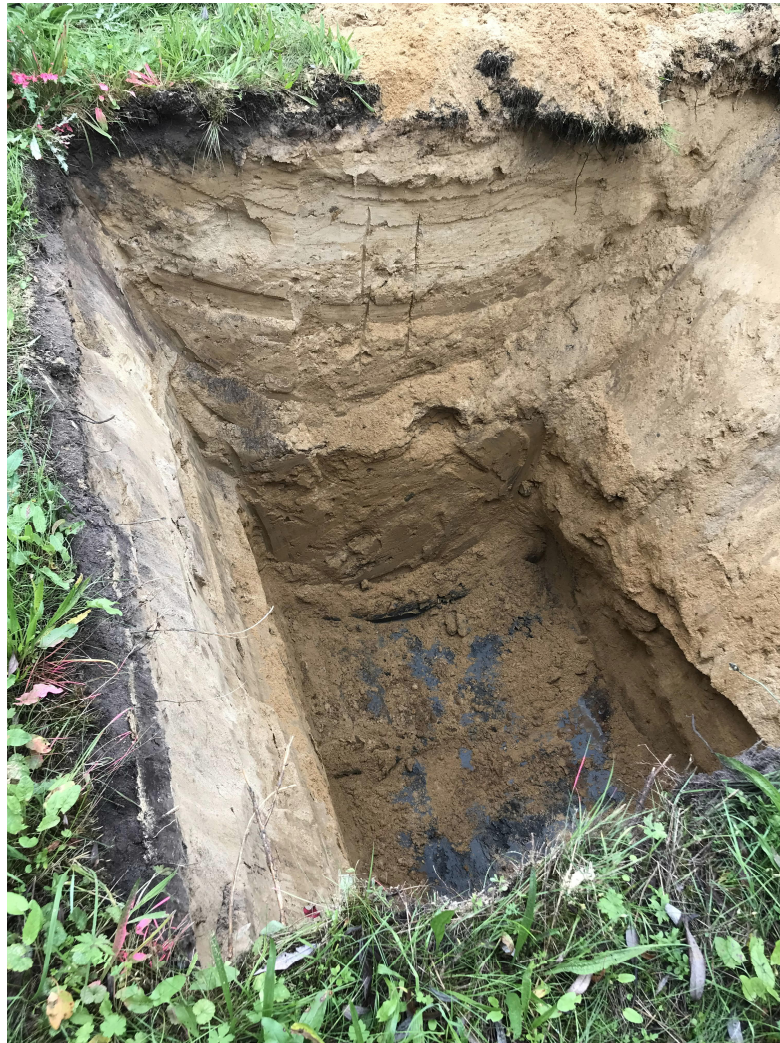
Abb. 1: Probeschurf A26-7054-Ost (ORW) zur Untersuchung des anfallenden Baugrubenwassers (östlicher Tunnelabschnitt – Segmente 09 bis 13, Lage des Schurfes siehe Anl. 1)
