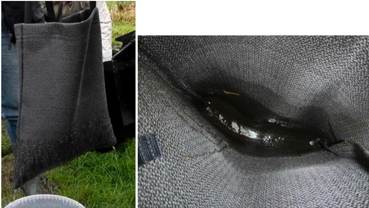
Abb. 12: In-Situ-Versuch zu den geotextilen Schläuchen im Rahmen der Probenahme zur Festlegung des Flockungsmittels und Blick in die Tasche mit ausgebildetem Filterkuchen nach etwa 0,5 h
