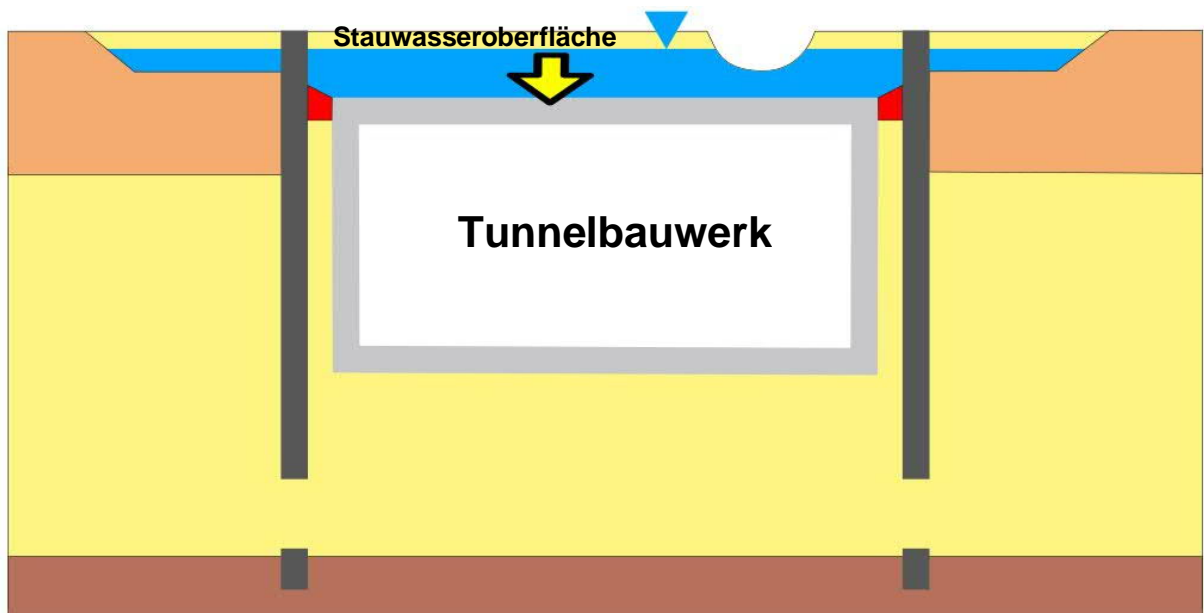
Abb. 22: Schema zur Kraftwirkung des Stauwassers
