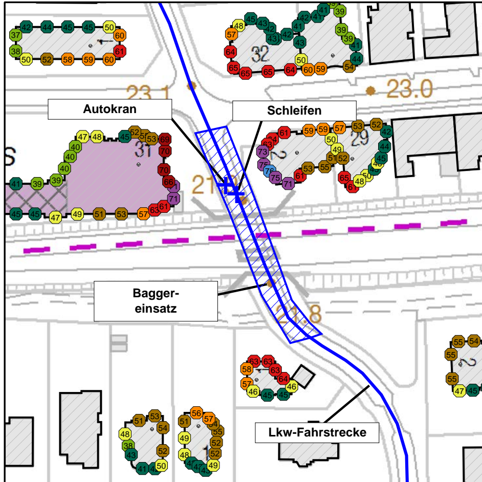
Abbildung 48. Bahnquerung, Bauphase Rohrverlegung , Beurteilungspegel tags, in dB(A).
