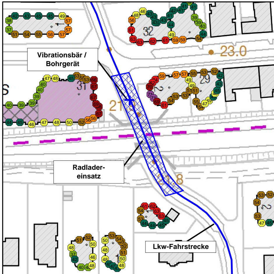
Abbildung 46. Bahnquerung, Bauphase Baugrube (Schächte) erstellen, Beurteilungspegel tags, in dB(A).
