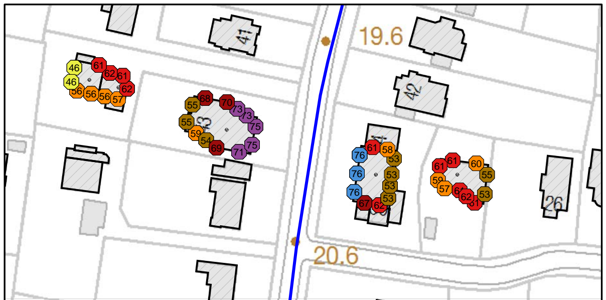
Abbildung 42. Lastfall Straßenaufbruch – Einsatz der Straßenfräse , Beurteilungspegel tags, in dB(A).
