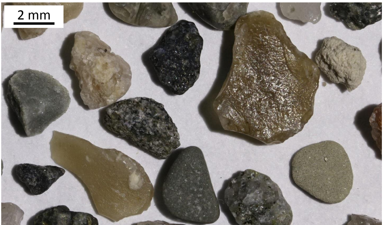
Fraktion > 2000 µm: Detailaufnahme Kies
