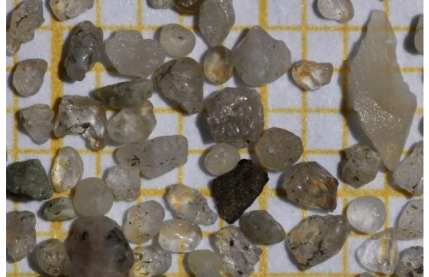
Fraktion 630 – 2000 µm: Grobsand
