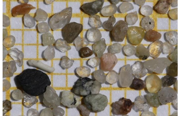
Fraktion 630 – 2000 µm: Grobsand
