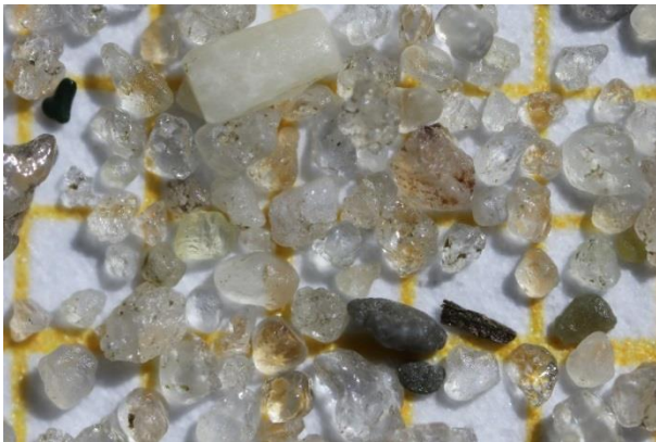
Fraktion 200 – 630 µm: Mittelsand
