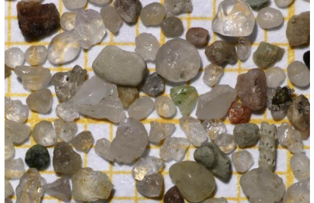
Fraktion 630 – 2000 µm: Grobsand
