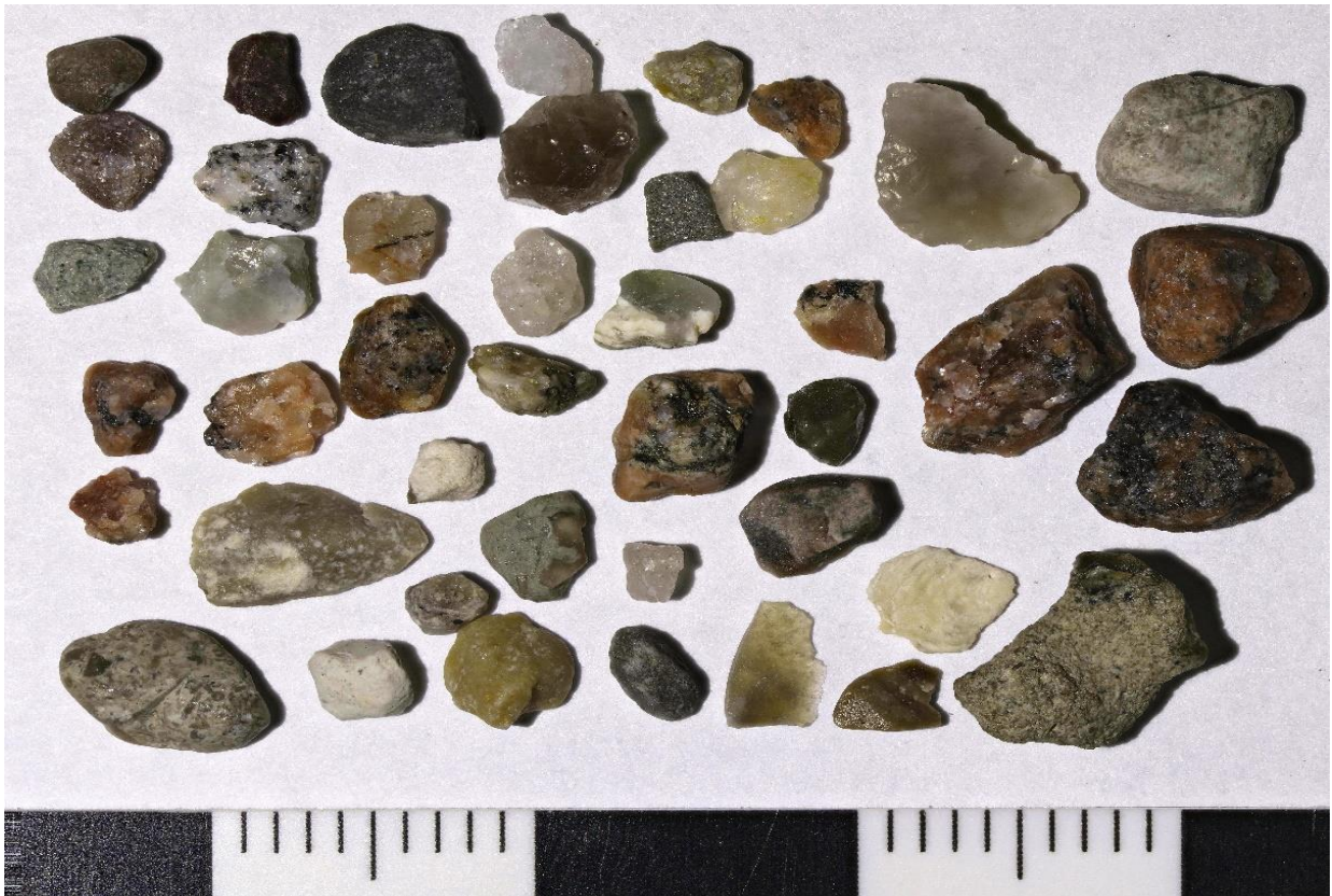
Abb. 1: Geschiebebruchstücke aus den Kiesfraktionen ( > 2\text{ mm} ) von Probe B 06 (Geschiebemergel) aus 27,0 bis 27,25 m Tiefe. Der Anteil an scharfkantigen Flinten beträgt ca. 20 %.
