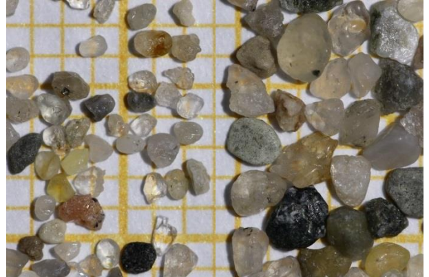
Fraktion 630 – 2000 µm: Grobsand
