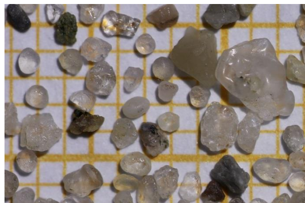
Fraktion 630 – 2000 µm: Grobsand
