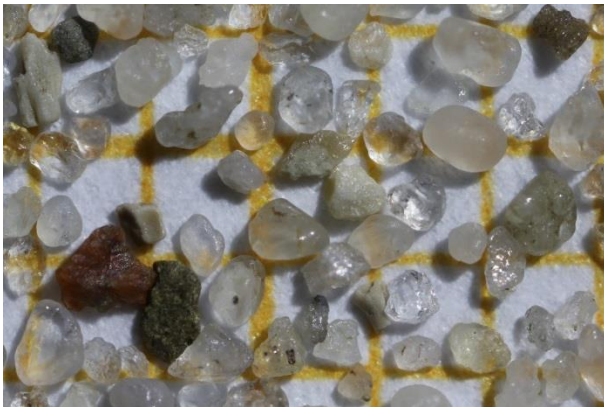
Fraktion 200 – 630 µm: Mittelsand
