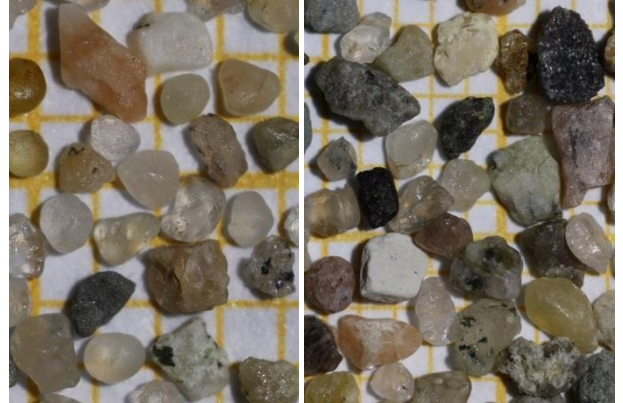
Fraktion 630 – 2000 µm: Grobsand
