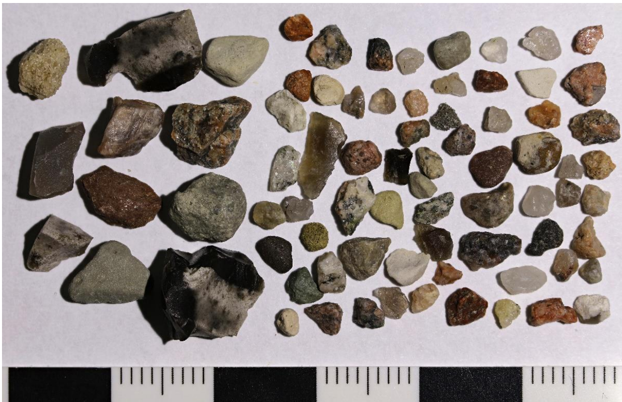
Abb. 2: Geschiebebruchstücke aus den Fraktionen 2000 – 8000 \mu\text{m} von Probe B 04 (kieshaltiger Mittelsand) aus 38,6 – 38,9 m Tiefe. Der Anteil an scharfkantigen Flinten liegt bei ca. 10 %.
