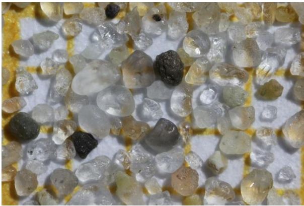
Fraktion 200 – 630 µm: Mittelsand
