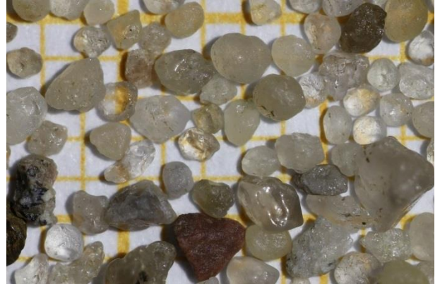
Fraktion 630 – 2000 µm: Grobsand
