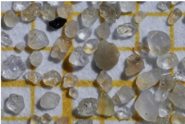
Fraktion 200 – 630 µm: Mittelsand
