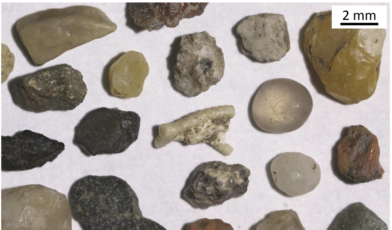
Fraktion > 2000 µm: Detailaufnahme Kies
