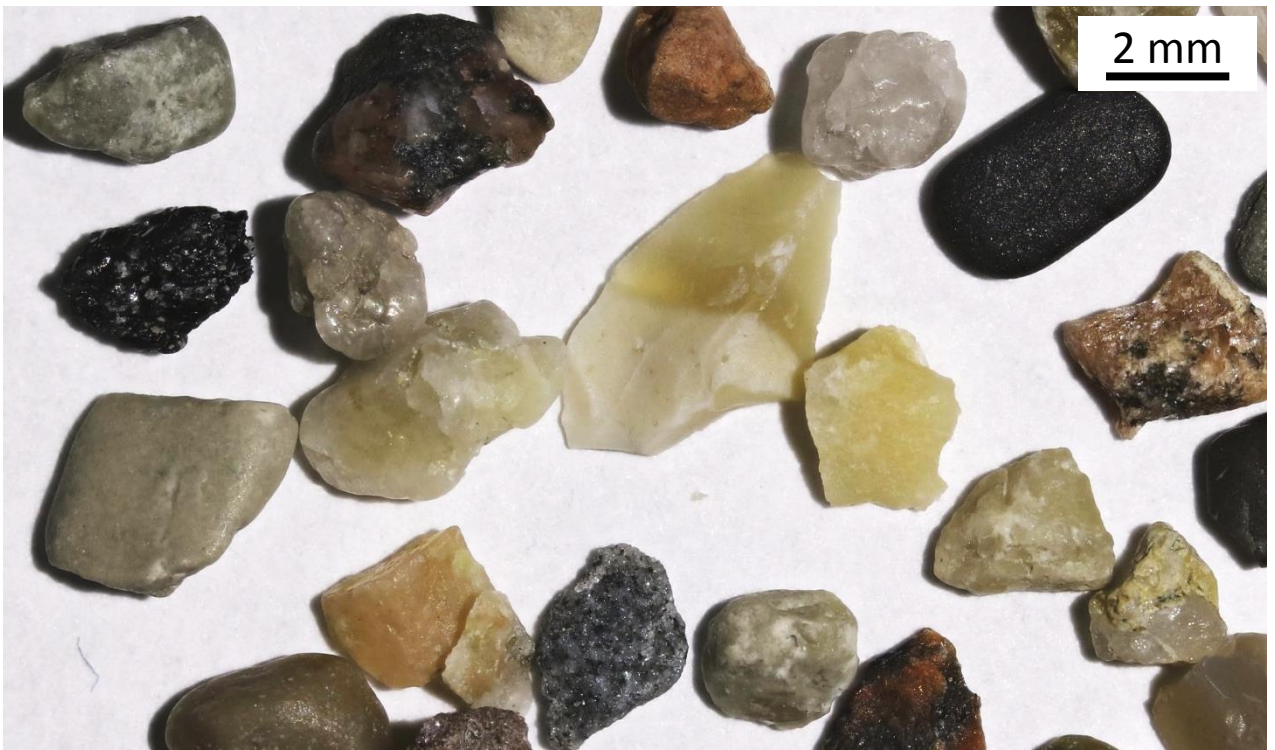
Fraktion > 2000 µm: Detailaufnahme Kies
