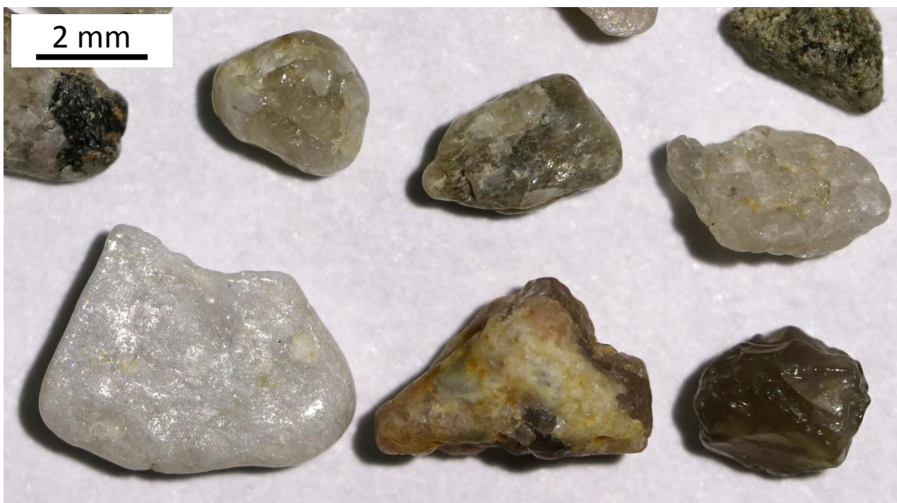
Fraktion > 2000 µm: Detailaufnahme Kies
