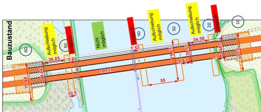
Abbildung 6.26: Auswertung eines möglichen Eisstaus und einer Eisaufschiebung an der Süderelbbrücke im Bauzustand, Details siehe Tabelle 6.2.
