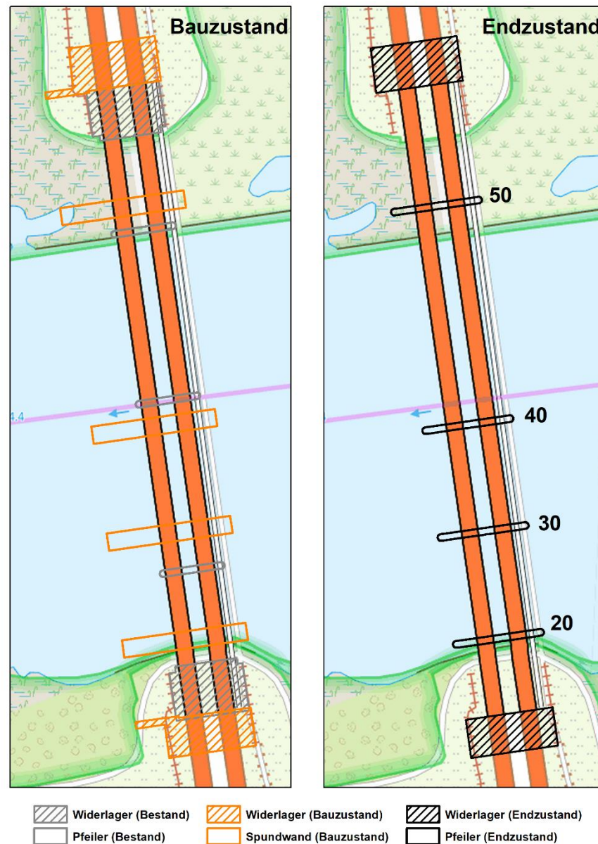
Abbildung 4.6: Lage und Nummerierung der Brückenpfeiler für die Bauphase 5 – 8 mit einbezogenen Spundwänden und bestehenden Brückenpfeilern (links), sowie für den Endzustand (rechts).
