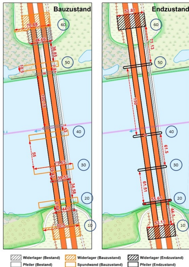
Abbildung 6.24: Maße der Pfeileranordnung im Endzustand (rechts) und der Pfeileranordnung im Bauzustand (links) an der Süderelbbrücke.
