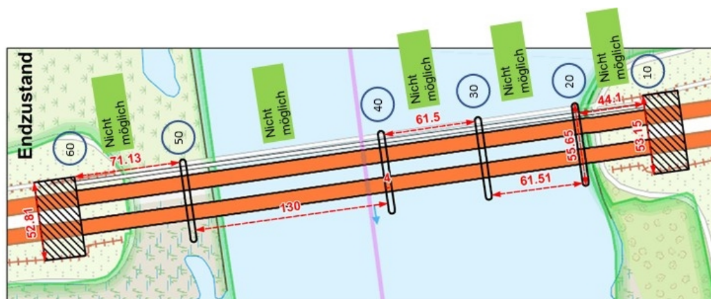
Abbildung 6.27: Auswertung eines möglichen Eisstaus und einer Eisaufschiebung an der Süderelbbrücke im Endzustand, Details siehe Tabelle 6.3
