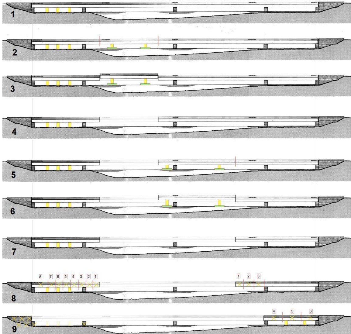
Abbildung 18: Rückbaukonzept der Bestandsbrücke ( Unterlage 16.2 , ABB. 16)
