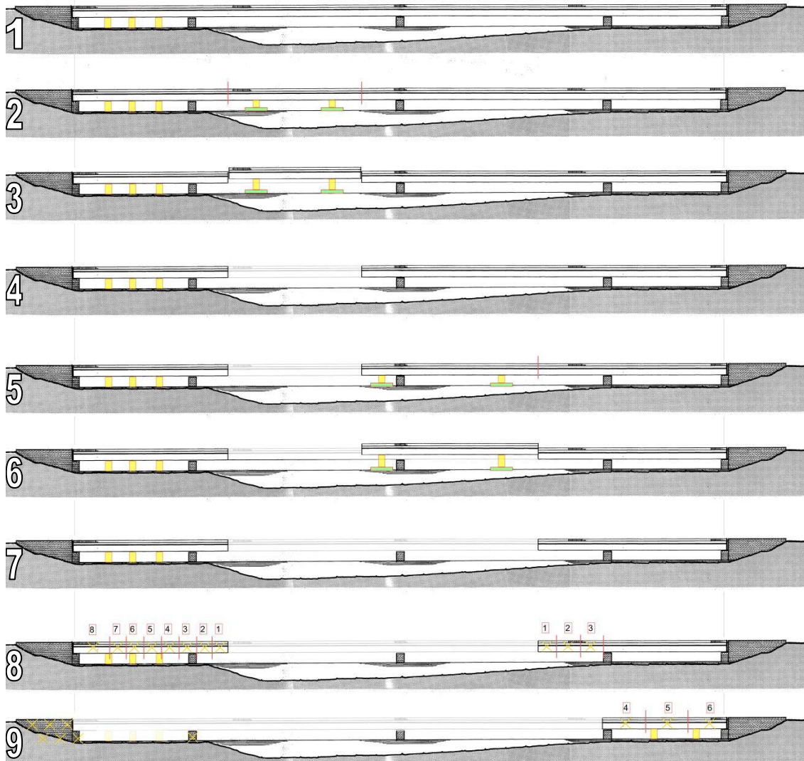
Abbildung 10: Rückbaukonzept der Bestandsbrücke (Unterlage 16.2)
