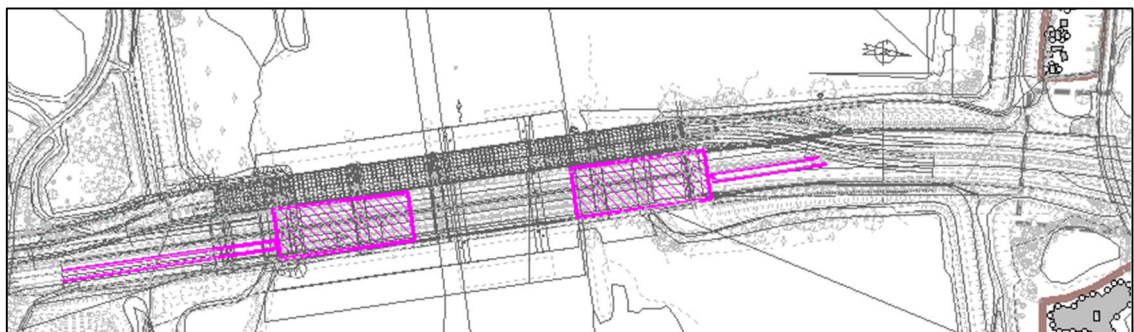
Abbildung 9: Schallquellen, Abbruch der Bestandsüberbauten der Süderelbbrücke (BW484)
