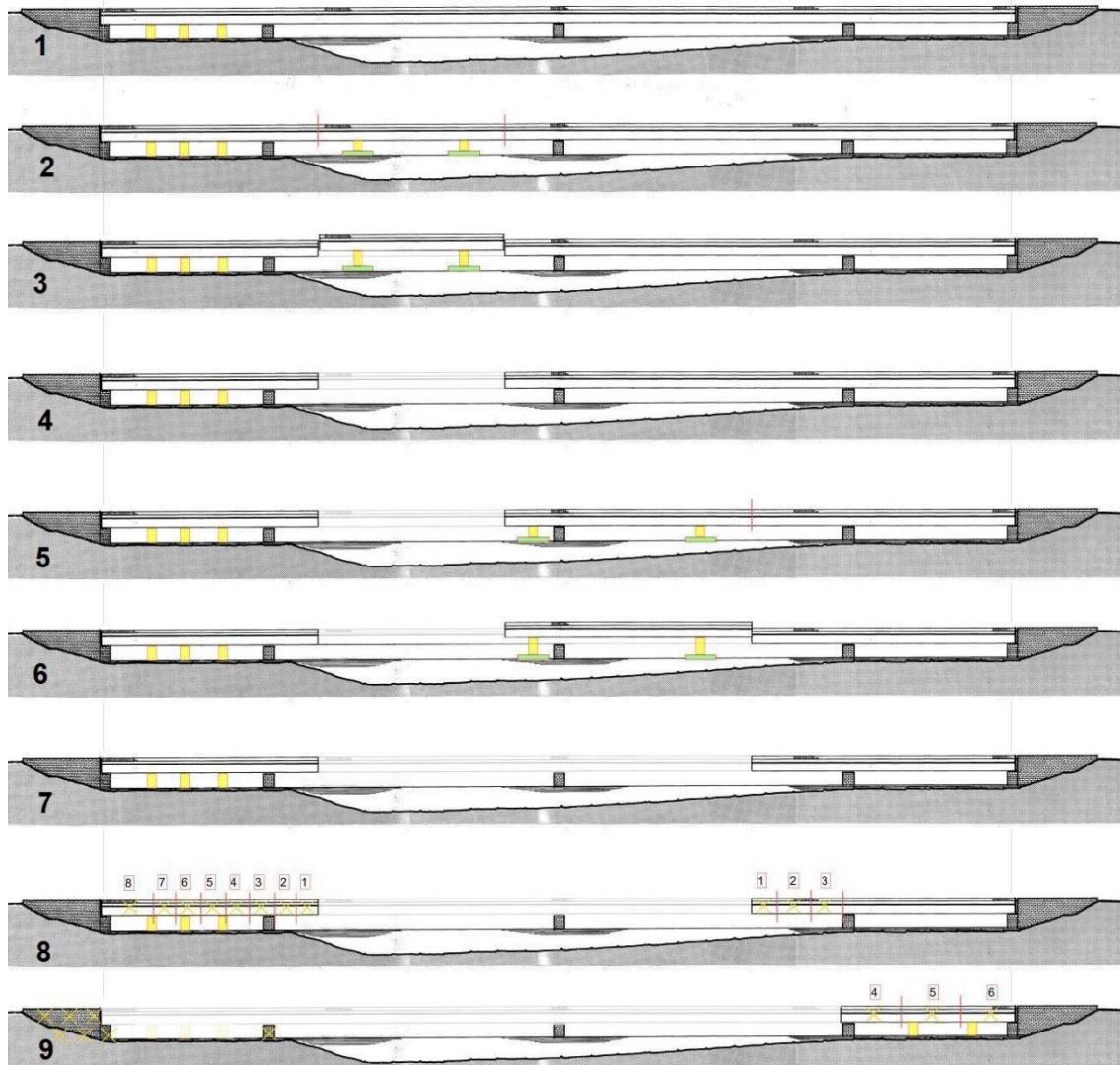
Abbildung 18: Rückbaukonzept der Bestandsbrücke (vgl. Unterlage 16.2 )
