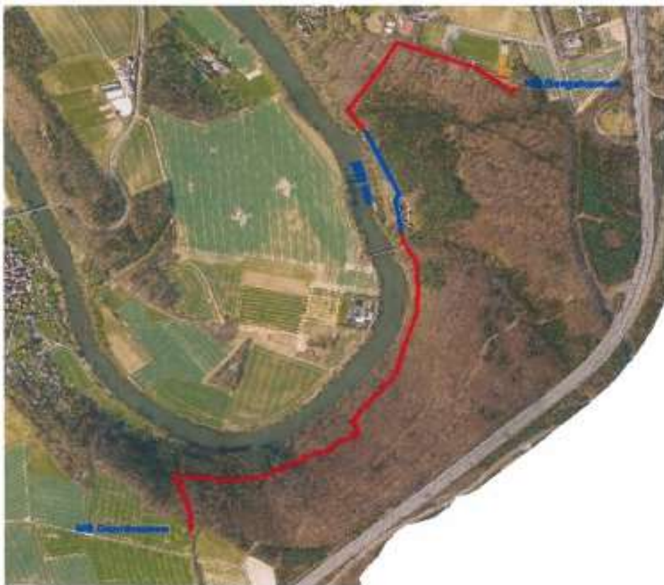
Abbildung 5: Wasserleitung HB Dennhausen nach HB Bergshausen (blauer Bereich erneuert)
