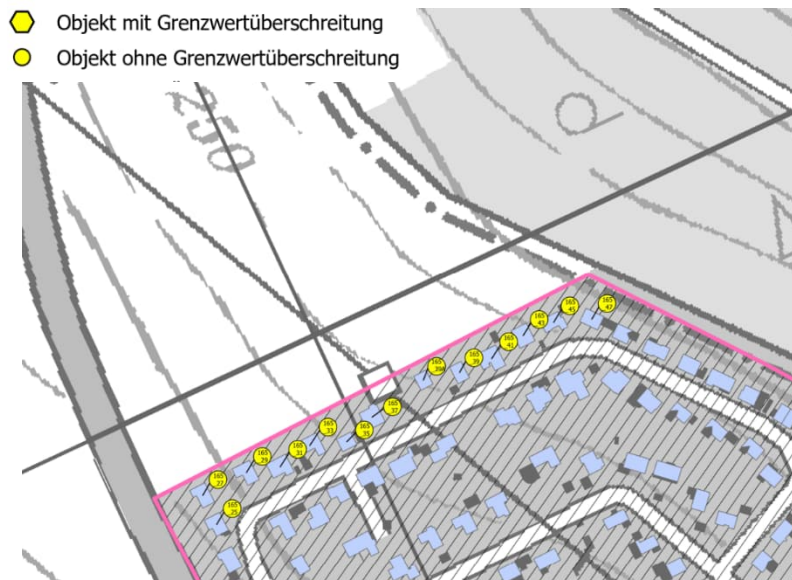
Abbildung 12: Durch den Ausbauabschnitt bedingten schalltechnischen Einwirkungen auf die Gebäude in Dörnhagen
