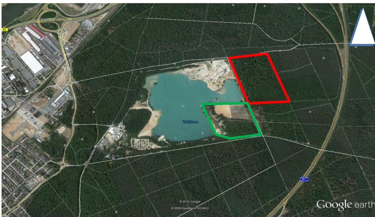
**Abbildung 2:** Luftbild bestehender Tagebau mit Eintragung Erweiterung OST1 (rot) und dem aktuellen Abbau SÜDOST (grün)
