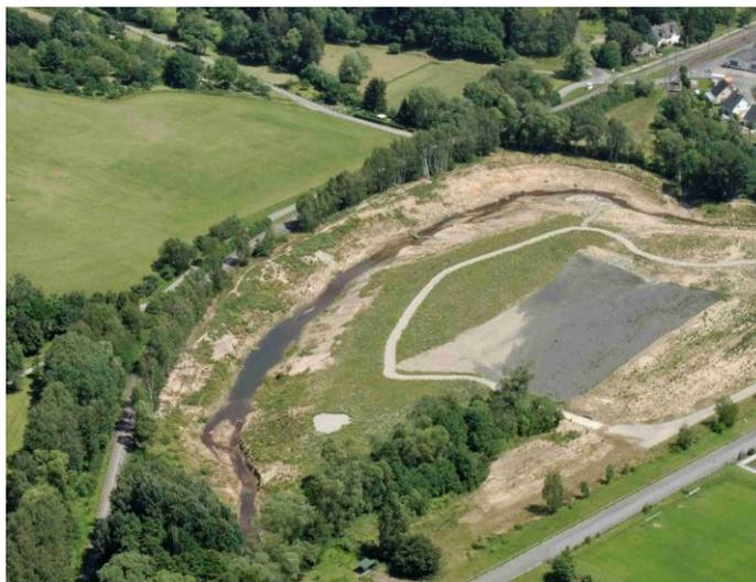
**Abbildung 4: Auf dem Gelände des ehemaligen Riffergeländes in Kaufungen wurde die zuvor in einem Betonkastengerinne kanalisierte Losse renaturiert und dabei ein Hochwasserretentionsraum von rund 67.000 m<sup>3</sup> Volumen geschaffen (Foto Bohnhardt/Gemeinde Kaufungen)**
