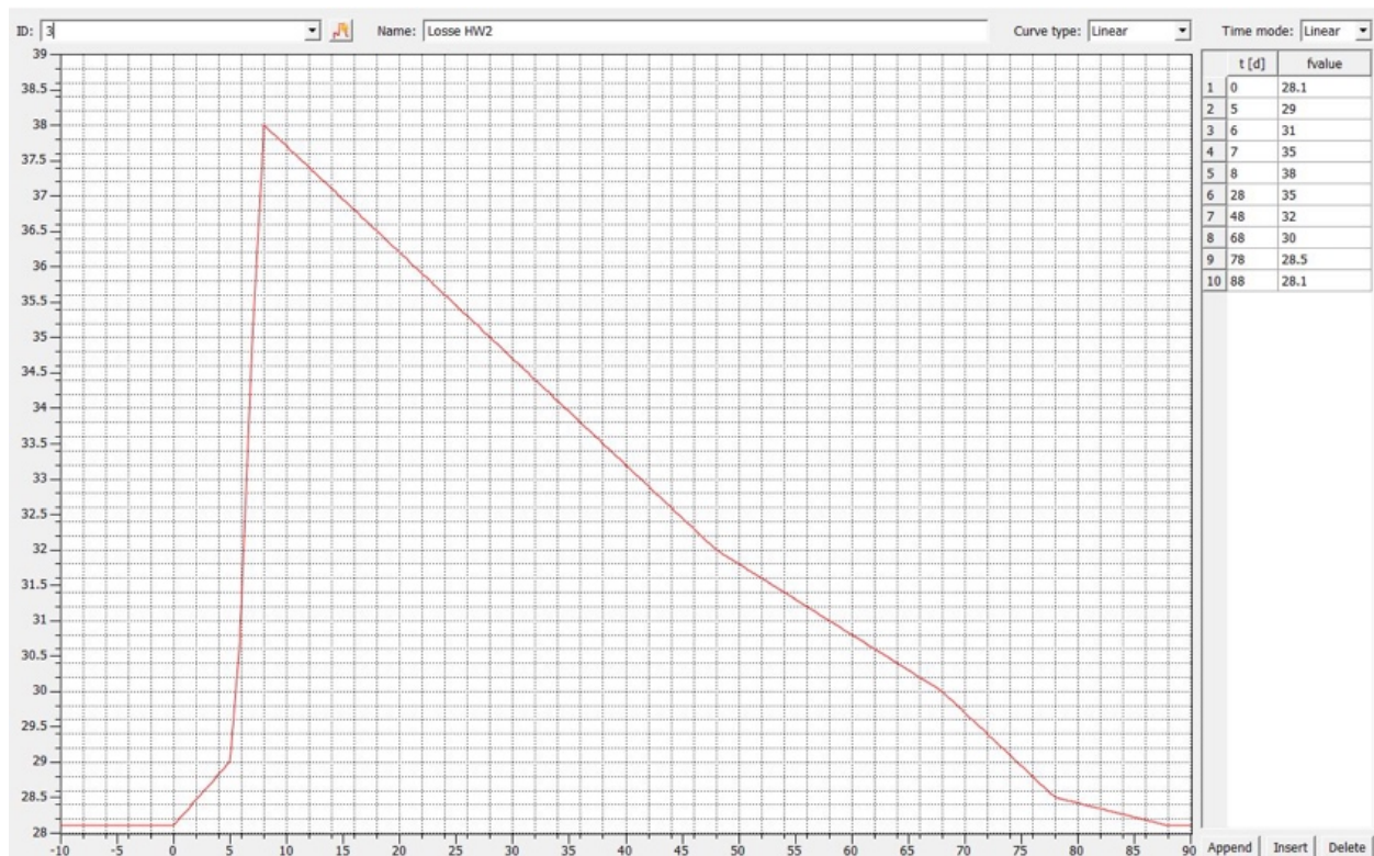
Wassereinstau HRB Helsa bis 289,80 mNHN, ca. 10 m über GOK
