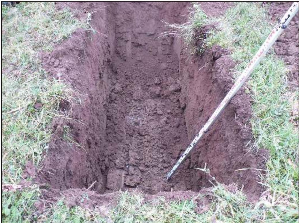
**Bild 4:** Baggerschurf. Oberflächennahe Bodenschichtung, Wasserzulauf bei ca. 1,5m u. GOK.
