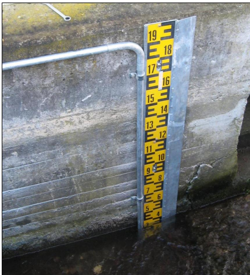
Abbildung 5-6: Pegellatte mit Anprallschutz und Messrohr (Beispielfoto)
