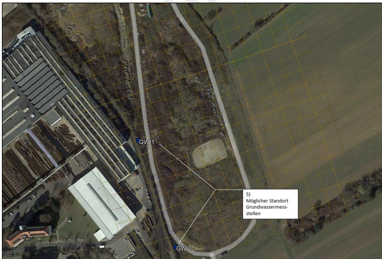
Abbildung 9: mögliche Lage der Grundwassermessstellen im Abstrom
