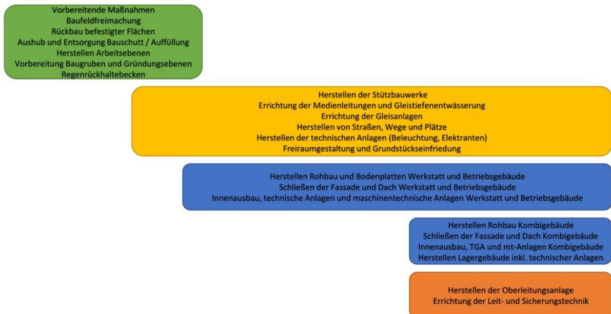
Abbildung 21 Schematischer Übersicht des Bauablaufs
