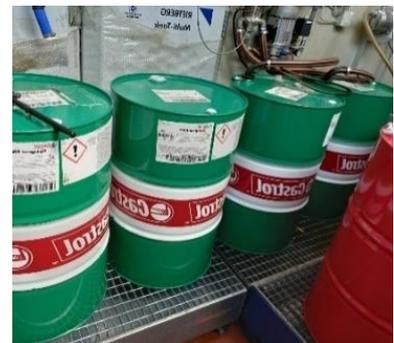
Abbildung 8 Beispielhafte Lagerung von Gefahrstoffen
