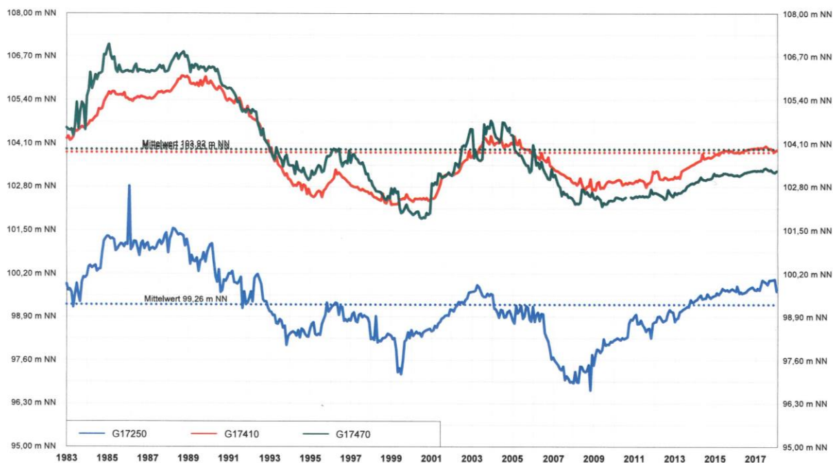
Abbildung 3: Grundwasserstandsganglinien im Bereich des WW Praunheim II (Quelle: Hessenwasser)
