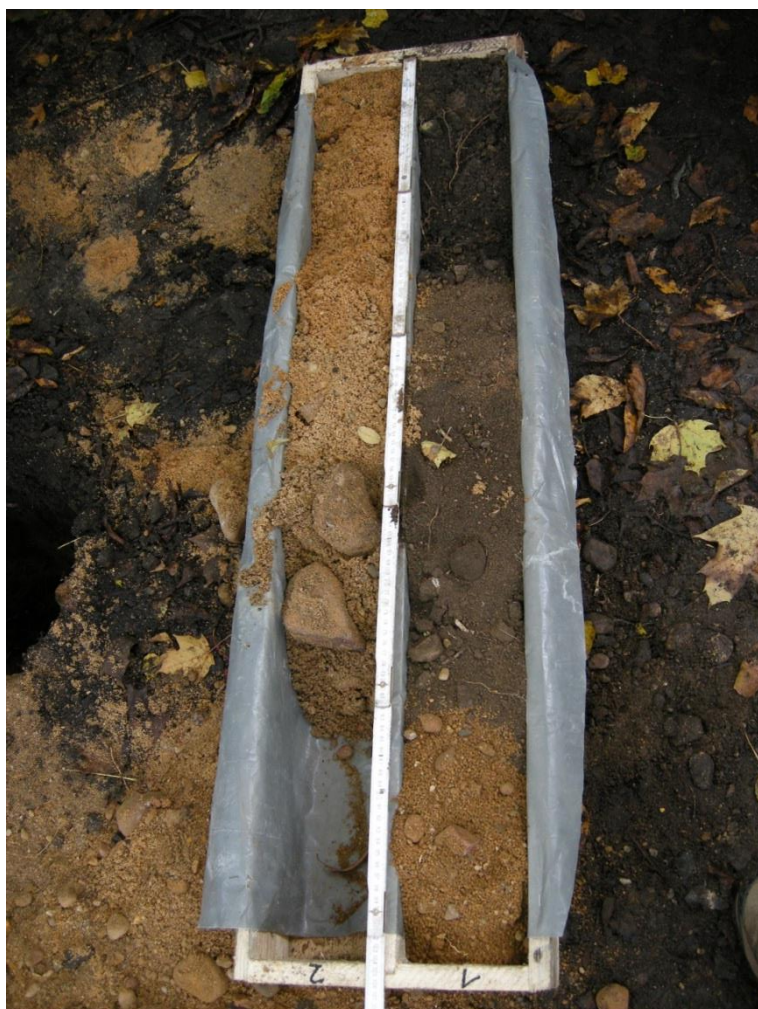
Abb. 6 Kernkiste Bohransatzpunkt 5 (- 0,8 m Auffüllungen, > 0,8 m C n )
