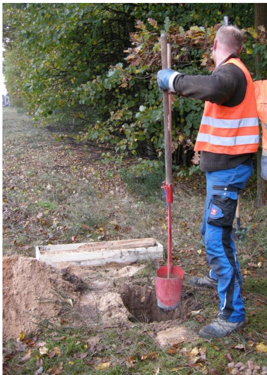
Abb. 1 Entnahme von Bodenmaterial mit dem Lochspaten
