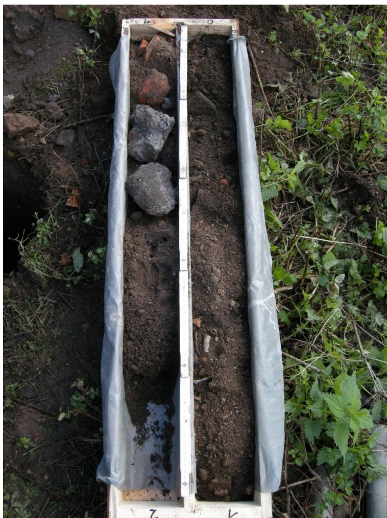
Abb. 5 Kernkiste Bohransatzpunkt 4 (Auffüllungen bis 1,8 m Tiefe)
