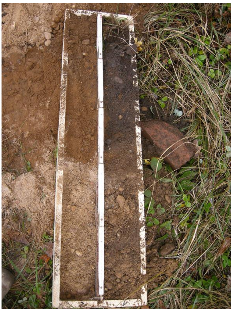
Abb. 8 Kernkiste Bohransatzpunkt 7 (- 1,5 m Auffüllungen, > 1,5 m C n )
