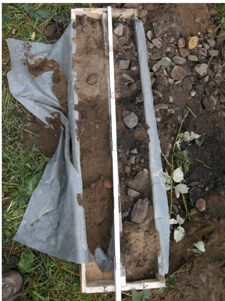
Abb. 4 Kernkiste Bohransatzpunkt 3 (Auffüllungen bis 1,8 m Tiefe)
