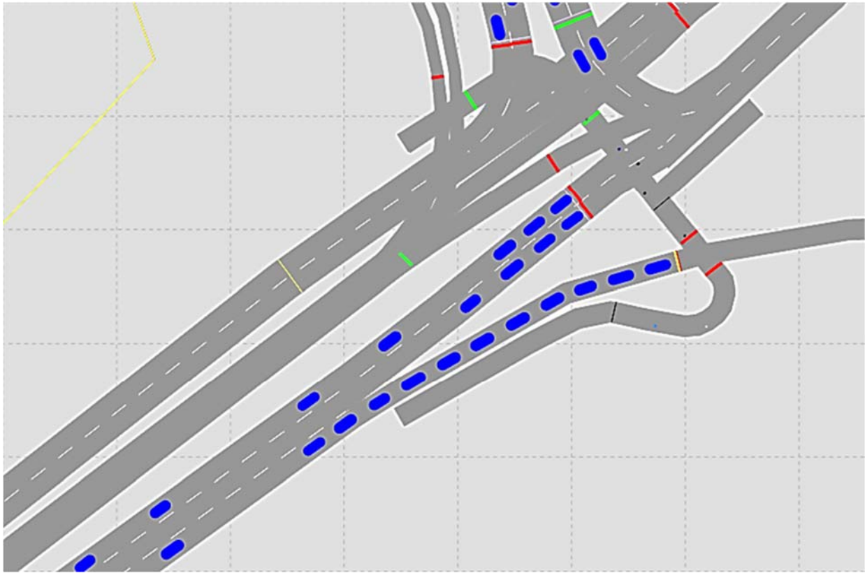
Abbildung 10: Maximaler Rückstau an der Rampe auf die A661 während der Sperrzeit
