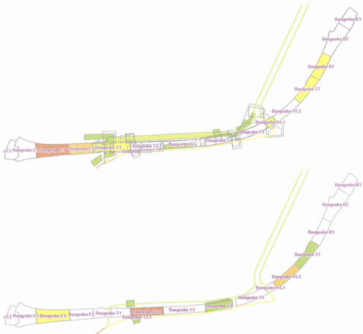
Abbildung 5-3: Verteilung der PM10-Emissionen auf den Baufeldern in relativer Darstellung (rot = hoch über gelb bis grün = gering) für Episode A (oben) und Episode B (unten)
