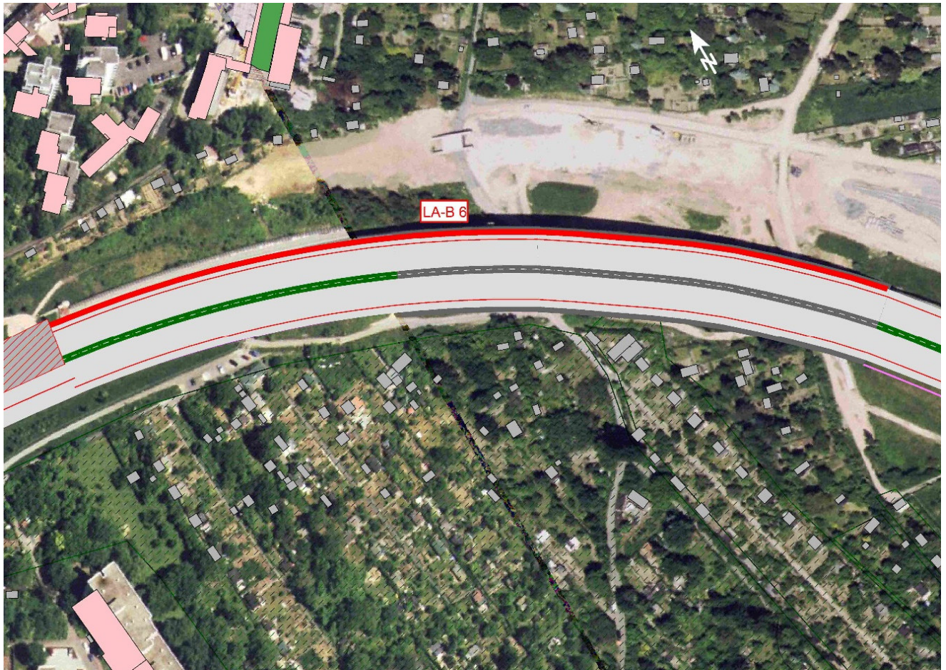
Abbildung 5 Lärmschutzwand im Bereich Seckbach [2]
