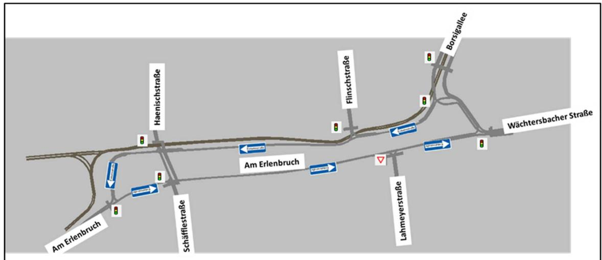
Abbildung 31: Darstellung der bauzeitlichen Verkehrsführung Am Erlenbruch
