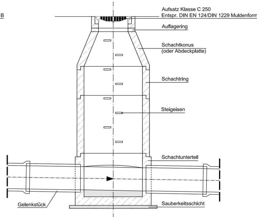
Schnitt Regelschacht DIN 4034
