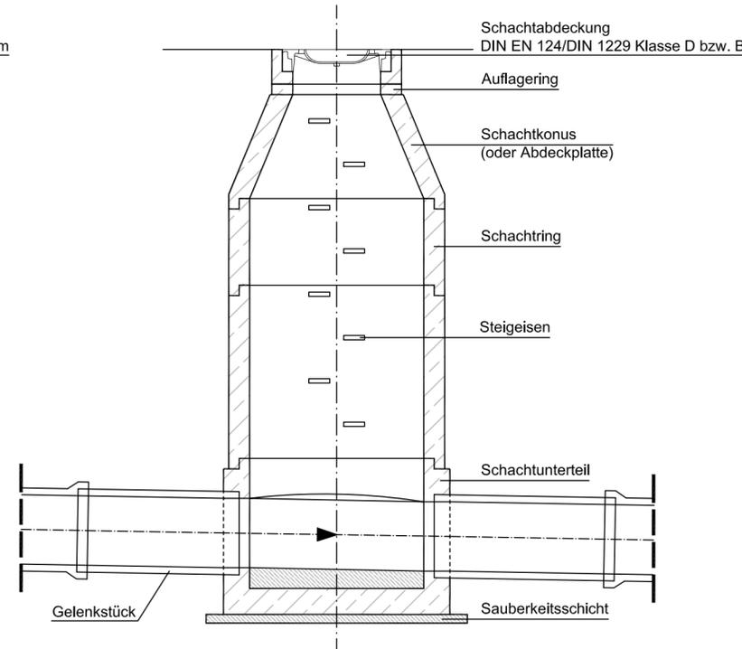
Grundriss Regelschacht DIN 4034
