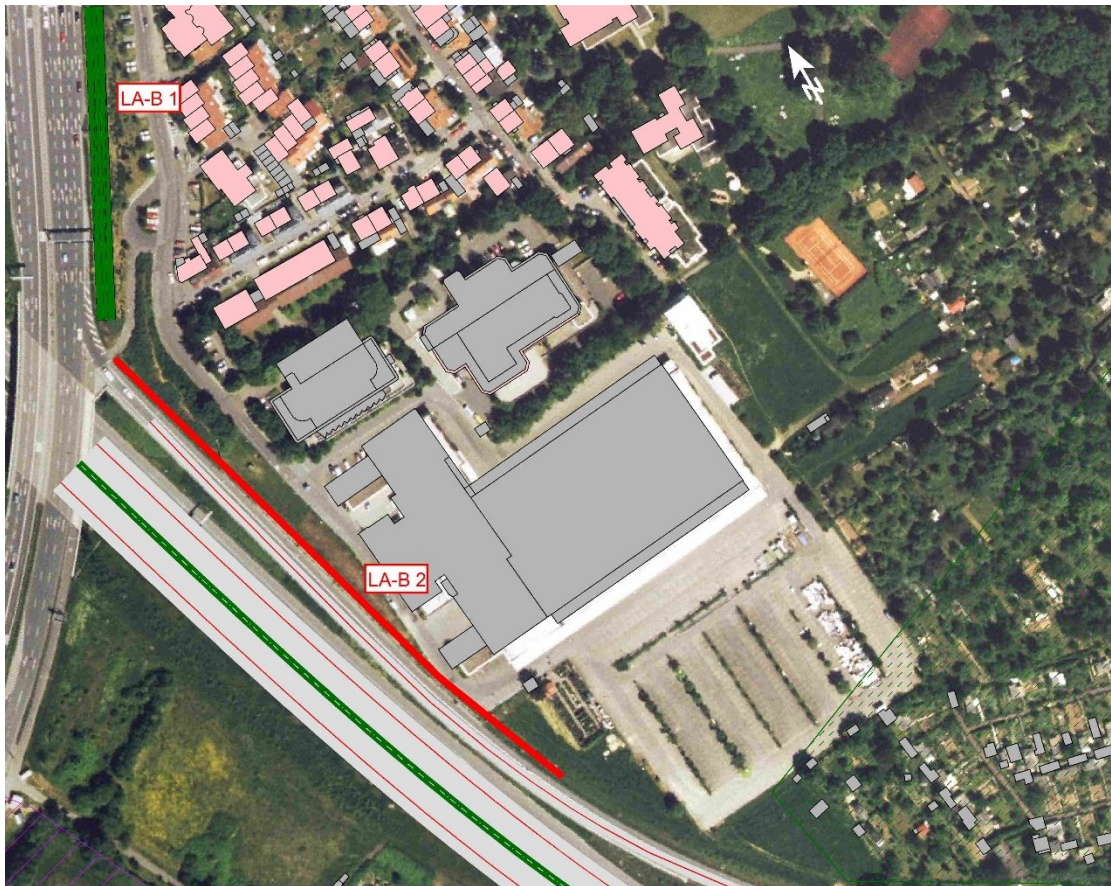
Abbildung 3 Übersicht der umgesetzten Lärmschutzmaßnahmen im Bereich Seckbach [2]
