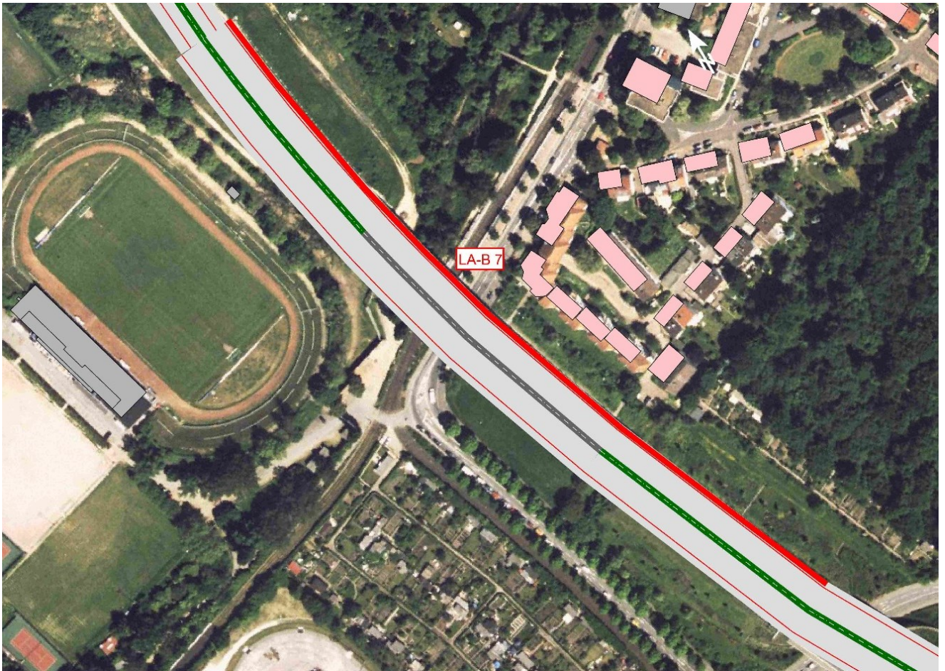
Abbildung 7 Lärmschutzwand im Bereich der Talbrücke Erlenbruch [2]
