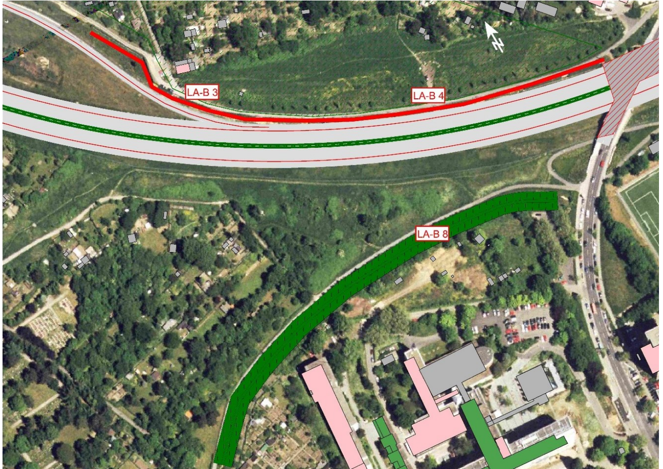
Abbildung 4 Übersicht der umgesetzten Lärmschutzmaßnahmen im Bereich "Katharinenkrankenhaus"[2]
