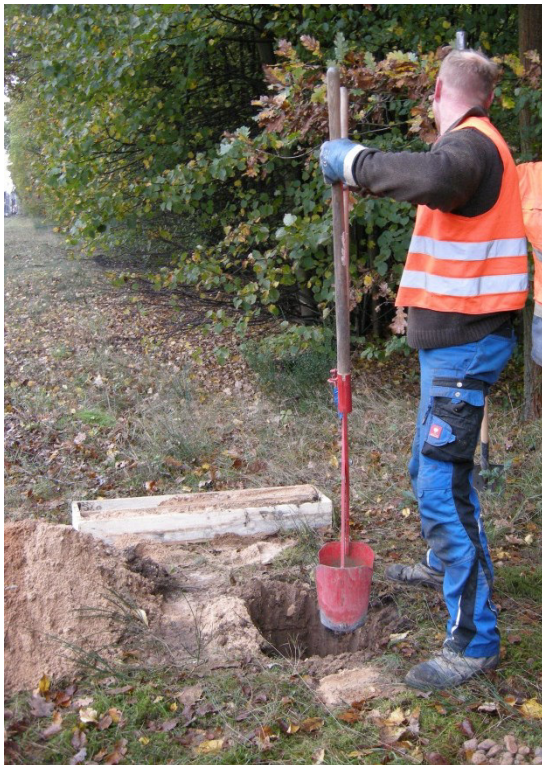
Abb. 1 Entnahme von Bodenmaterial mit dem Lochspaten
