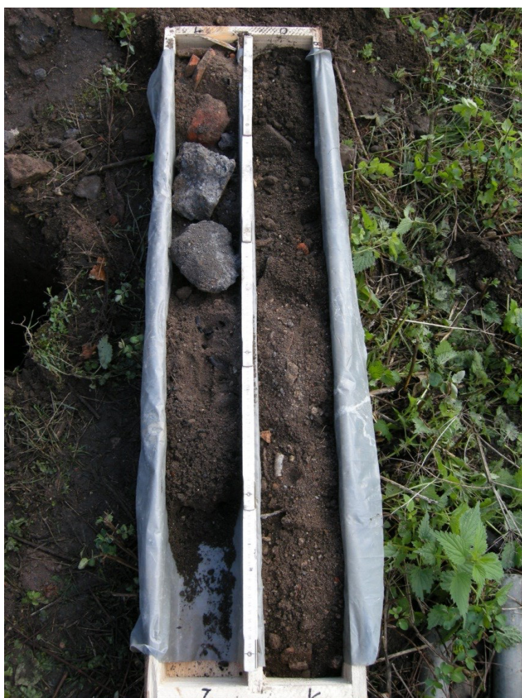
Abb. 5 Kernkiste Bohransatzpunkt 4 (Auffüllungen bis 1,8 m Tiefe)
