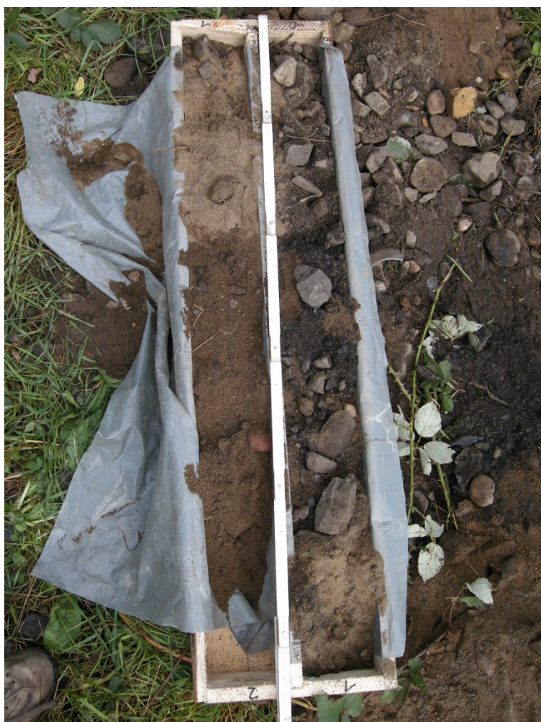
Abb. 4 Kernkiste Bohransatzpunkt 3 (Auffüllungen bis 1,8 m Tiefe)
