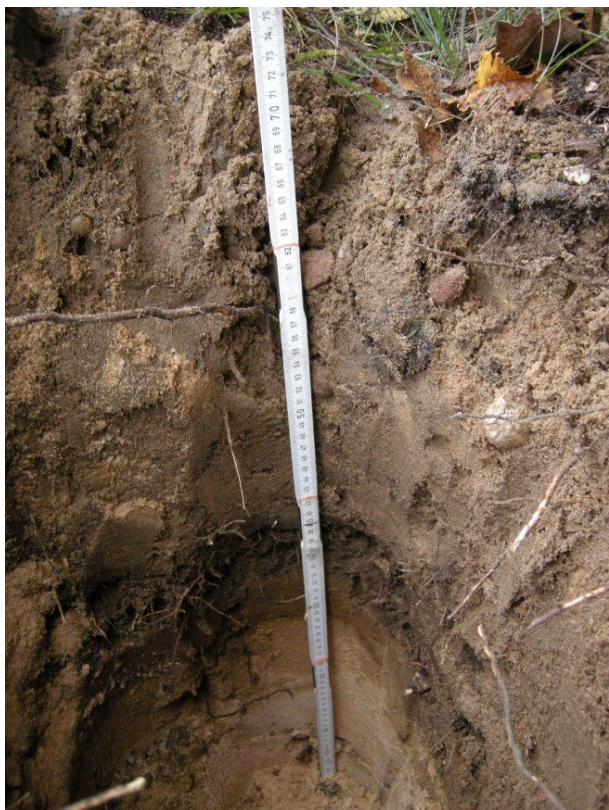
Bohrloch bei ca. 75 cm Tiefe, Bohransatzpunkt 6
