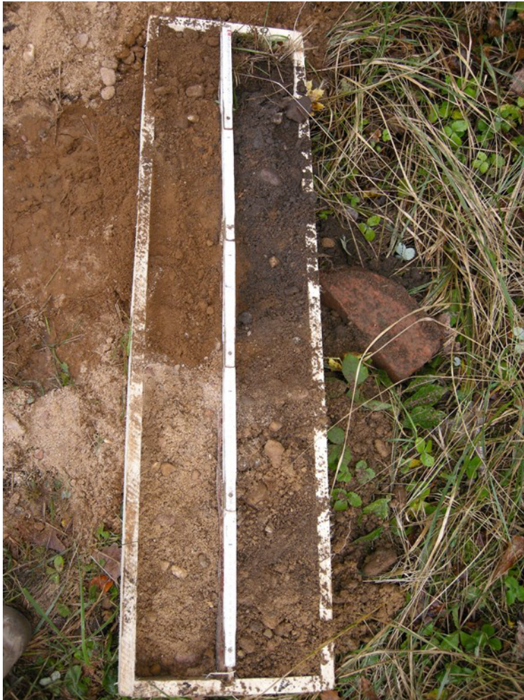
Abb. 8 Kernkiste Bohransatzpunkt 7 (- 1,5 m Auffüllungen, > 1,5 m C n )
