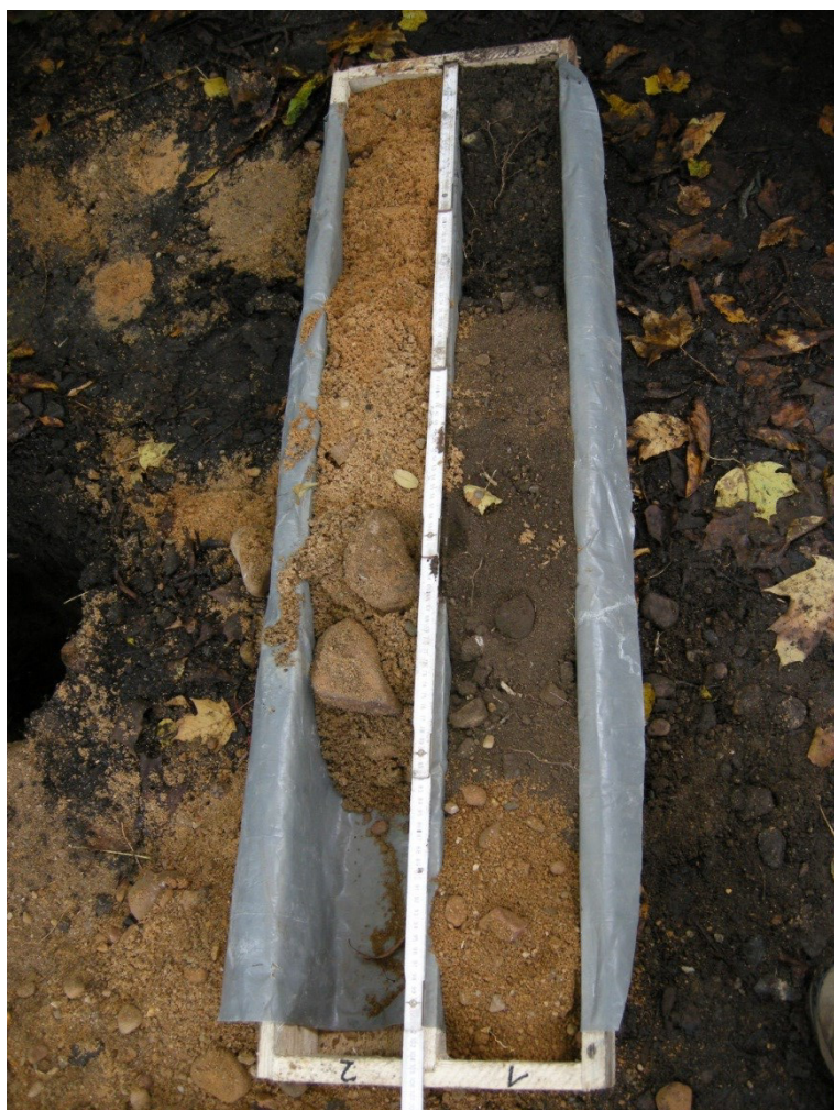
Abb. 6 Kernkiste Bohransatzpunkt 5 (- 0,8 m Auffüllungen, > 0,8 m C n )
