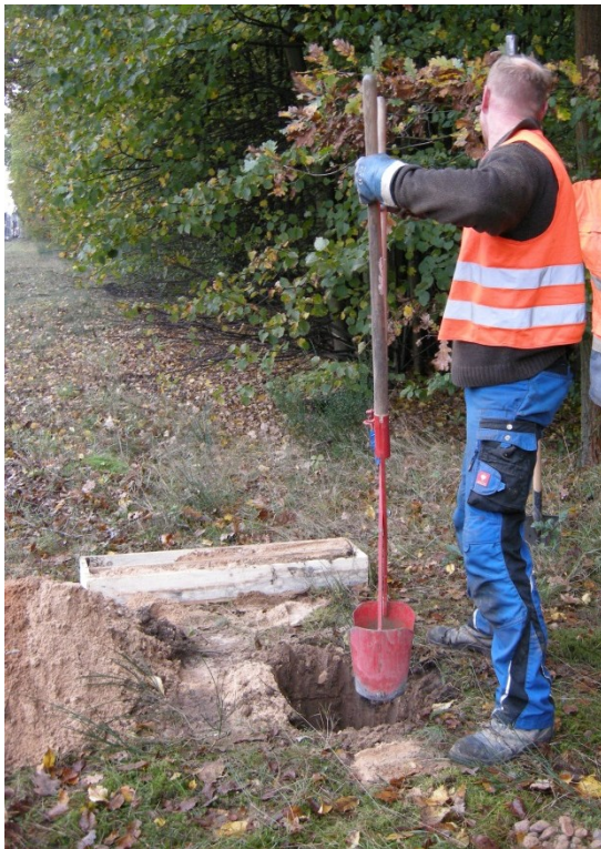
Abb. 1 Entnahme von Bodenmaterial mit dem Lochspaten
