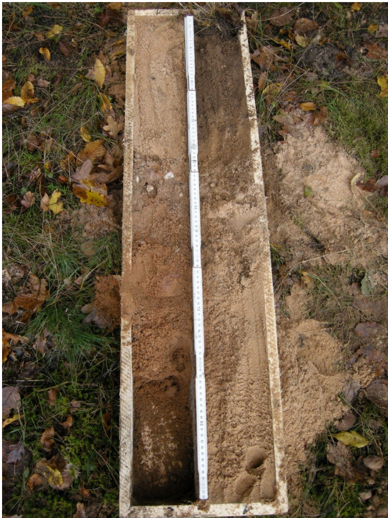
Abb. 7 Kernkiste Bohransatzpunkt 6 (- 0,1 m A_h , - 0,4 m B_v , > 0,4 m C_n )
