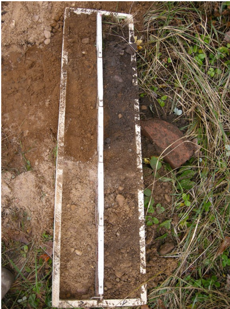
Abb. 8 Kernkiste Bohransatzpunkt 7 (- 1,5 m Auffüllungen, > 1,5 m C n )
