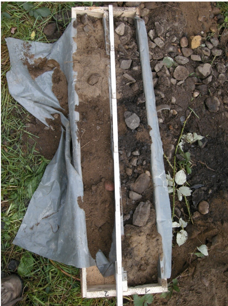
Abb. 4 Kernkiste Bohransatzpunkt 3 (Auffüllungen bis 1,8 m Tiefe)
