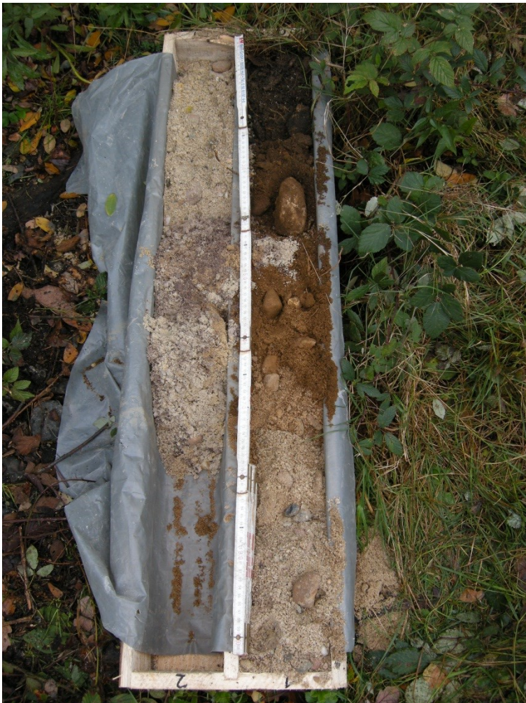
Abb. 2 Kernkiste Bohransatzpunkt 1 (- 0,2 m A_h , ~ 0,7 m B_v , > 0,7 m C_n )
