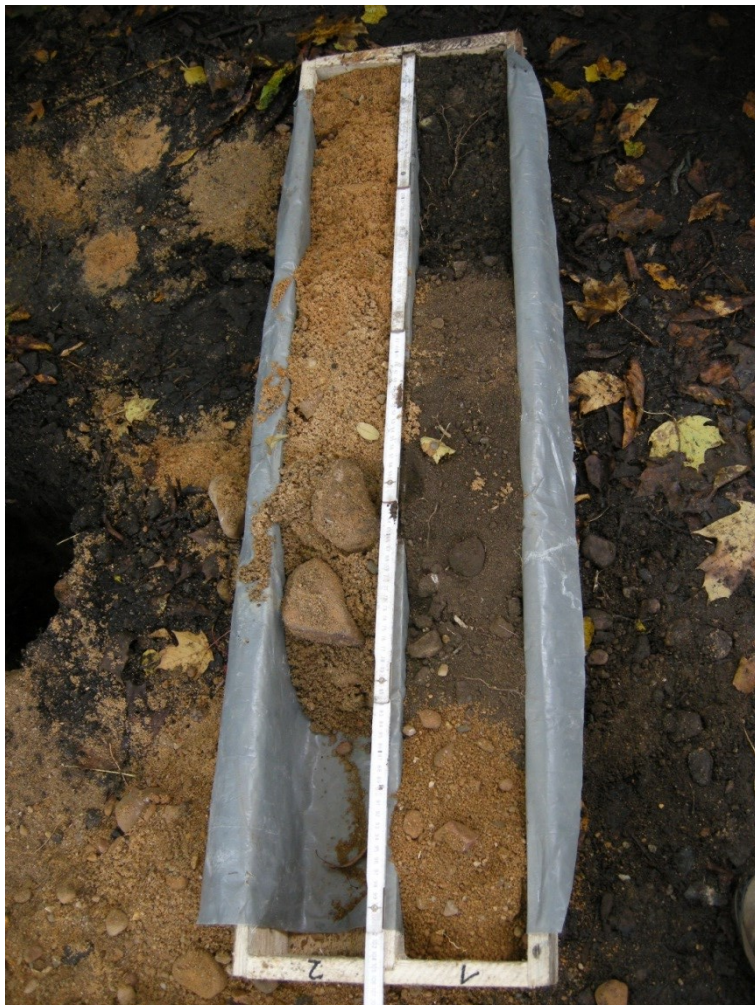
Abb. 6 Kernkiste Bohransatzpunkt 5 (- 0,8 m Auffüllungen, > 0,8 m C n )
