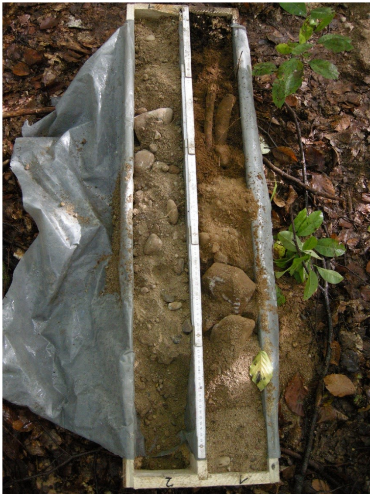
Abb. 3 Kernkiste Bohransatzpunkt 2 (- 0,2 m A_h , ~ 0,7 m B_v , > 0,7 m C_n )
