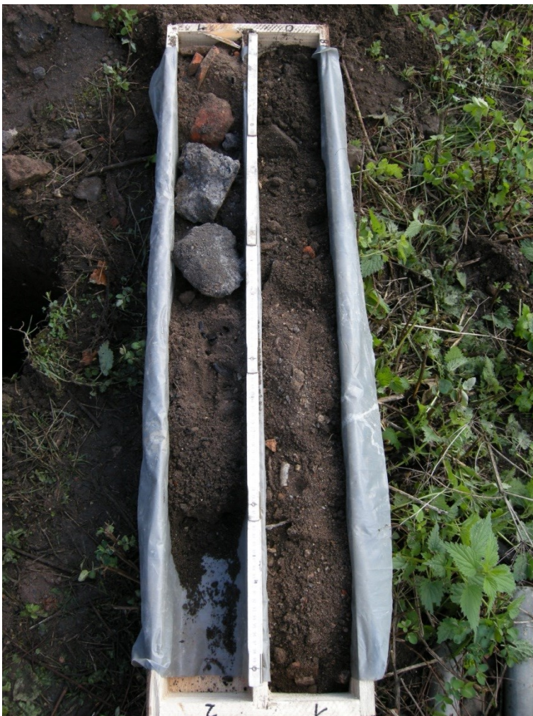
Abb. 5 Kernkiste Bohransatzpunkt 4 (Auffüllungen bis 1,8 m Tiefe)
