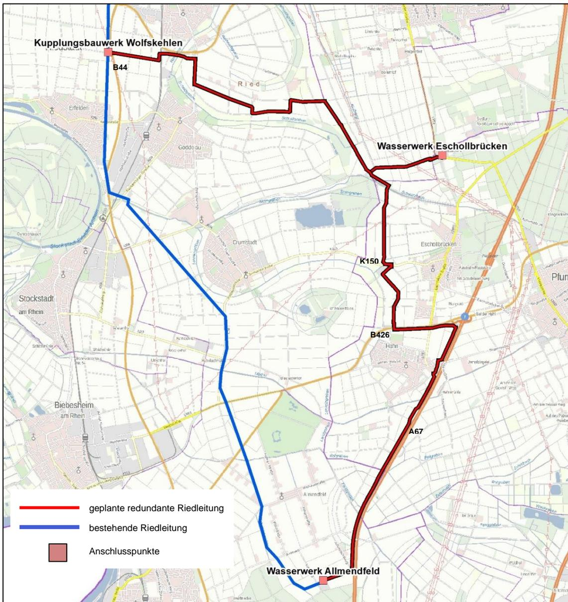
Abbildung 1 Übersicht Trassenverlauf R2S
