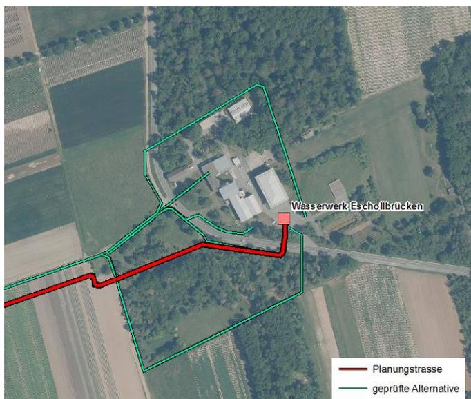
Abbildung 8 Optimierung 6: Trassenvarianten Anschluss WW Eschollbrücken
