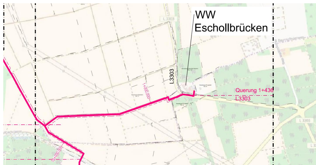
Abbildung 2-20: Planausschnitt Anschlussleitung WW Eschollbrücken
