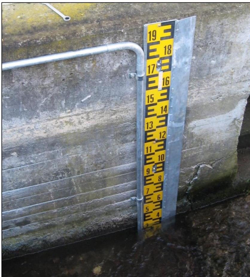
Abbildung 5-8: Pegellatte mit Anprallschutz und Messrohr (Beispielfoto)
